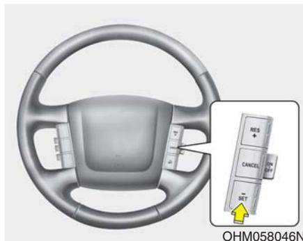
3. 按下-/SET开关并在达到需要的速度时释放，仪表盘中的SET指示灯亮起，同时释放加速踏板，则车辆会自动保持该设定的速度。
