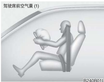
前空气囊总成位于方向盘的中央和杂物箱上方的助手席前仪表盘罩内。SRSCM检测到车辆的前碰撞严重性达到一定程度时，会自动展开前空气囊。
