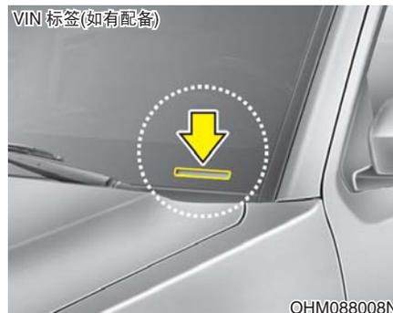
在粘贴在仪表盘罩上部的铭牌上也有车架号(VIN)。铭牌上的车架号通过挡风玻璃在外部很容易看到。
