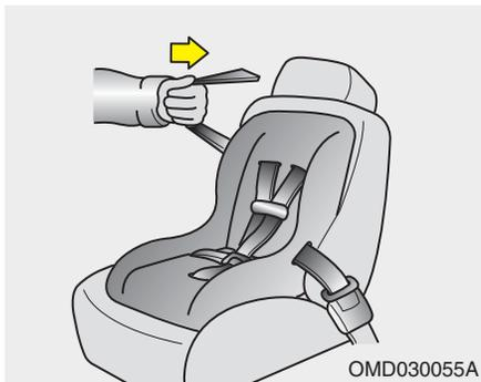
4. 缓慢地缩回安全带的肩带，并应听到明显的‘咔嗒声’或‘棘轮转动’的声音。这表明卷带器处于‘自动锁止’模式。如果没有听到明显的声音，重复步骤3和步骤4。
