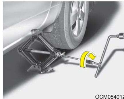
8. 把千斤顶手柄插入千斤顶并顺时针旋转。举升车辆直到轮胎离地，离地间隙约30mm(1.2in)。拆卸车轮螺母前，确认车辆平稳，并且没有滑动或移动的危险。
