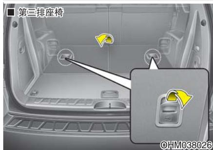
5. 要使用后座椅，通过拉动座椅靠背折叠杆提升并向后拉座椅靠背。牢固拉动座椅靠背直到伴随着咔嚓声锁定位，确定座椅靠背锁定。
