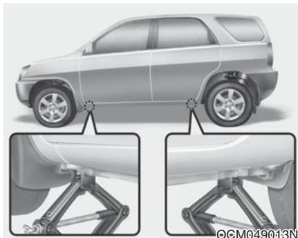
7. 把千斤顶放在最接近被换的轮胎的前顶起部位或后顶起部位，把千斤顶放在车架下的指定位置。顶起部位是焊接到车架上、通过两个凸舌和一个隆起点来指引千斤顶的平板。
