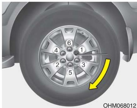
如图示定位扳手并拧紧车轮螺母。确认套筒完全套上螺母。切勿站在扳手的把手上或在扳手的把手上使用一个延长管。
