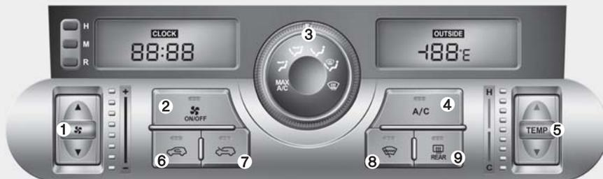
1. 鼓风机速度控制开关
