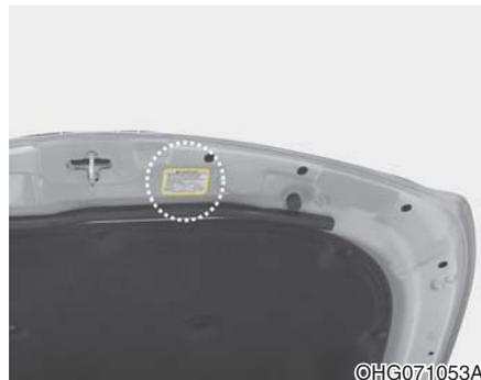
制冷剂标签位于发动机罩内侧板上。
