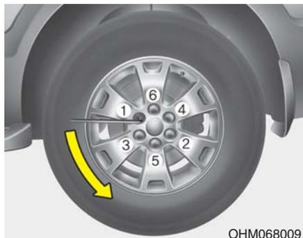
6. 每次向逆时针方向转动每个轮胎螺母一圈来松动轮胎螺母，但在轮胎离地之前不要拧下螺母。
