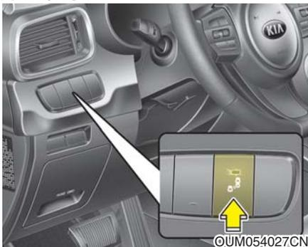
在点火开关ON状态按下后侧方盲区警告(BSD)系统开关时, 开关上的指示灯亮。如果车速超过30km/h, 系统启动。如果再次按下开关, 开关指示灯和系统将OFF。
