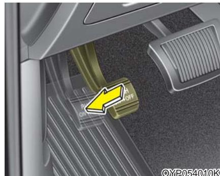
要释放驻车制动装置，使用脚制动器第二次踩下驻车制动踏板。踏板会自动恢复到完全释放位置。
