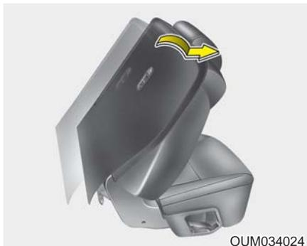
3. 折叠第2排座椅靠背并将座椅向前滑动到最前位置。
