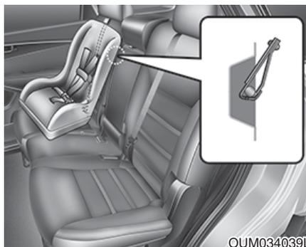
1. 将儿童保护系统顶部固定带置于座椅靠背上方。对于配备可调整头枕的车辆来说，把顶部固定带置于头枕下方和头枕两柱之间，否则把顶部固定带置于座椅靠背顶部上方。如果儿童保护系统与头枕之间发生干扰，拆卸个别头部保护系统，以便更好地装配儿童保护系统。
