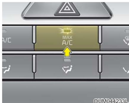
要选择MAX A/C，将鼓风机速度控制钮转至右侧并按下MAX A/C按钮。气流流向身体上部和脸部。在此模式内，自动选择空调和内气循环位置。
