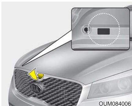
制冷剂标签位于发动机罩底部。
