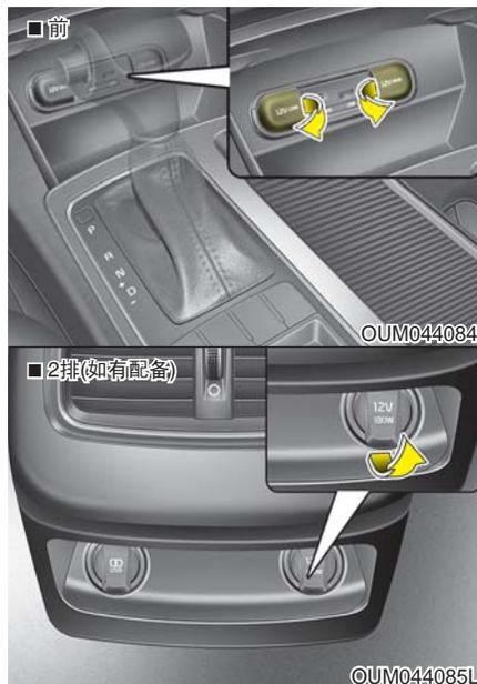
电源插座用于给移动电话或其它与车上的电气系统一起工作的装备提供电源，发动机运转时此插座可获得10安培以下的电流。
