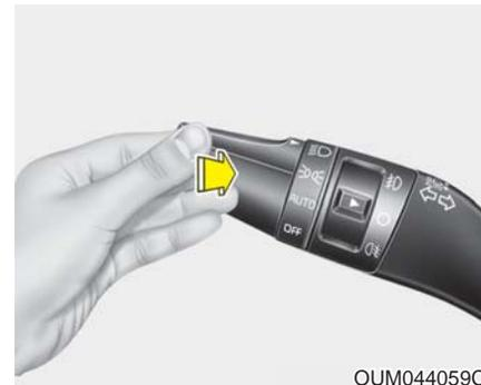
要打开大灯远光，应向远离您的方向推动灯光控制杆。控制杆会返回到原位置。
