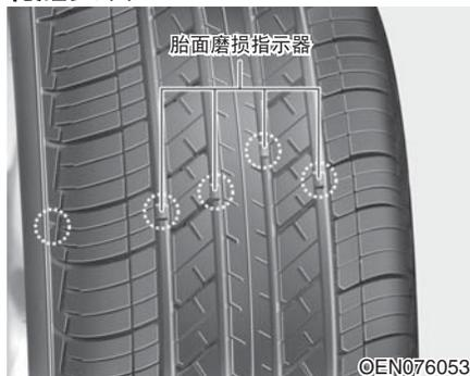
如果轮胎磨损均匀，胎面磨损指示器将出现横过胎面的硬带，这表示胎面剩余厚度小于1.6mm，此时应更换轮胎。
