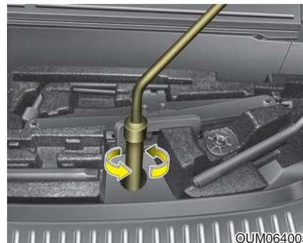
3. 连接套筒和轮毂螺母扳手。
