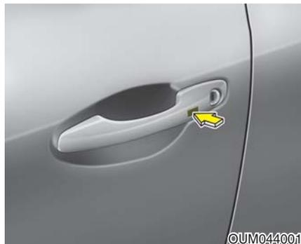
在所有车门(和后备箱门)关闭并且任意车门处于开锁状态按下前车门外侧手柄上的按钮，所有车门(前外侧车门把手)闭锁。危险警告灯闪烁一次，指示所有车门(和后备箱门)闭锁。
