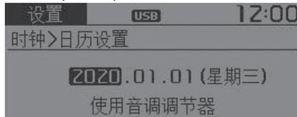
※ 调整焦点内的当前数字进行设置并按下 **TUNE** 旋钮移到下一设置。(按年/月/日顺序设置)
