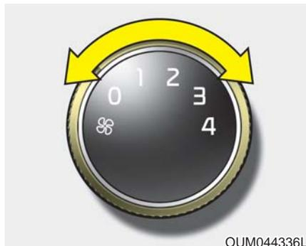
点火开关必须在ON位置才能进行鼓风机操作。
