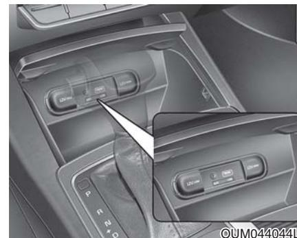
您可使用Aux接口连接音响播放设备，使用USB接口连接USB设备，使用iPod®接口连接iPod®设备。
