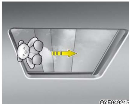
如果检测到物体或车身部件天窗玻璃或遮阳板自动关闭时，它将朝向相反的方向并停止。
