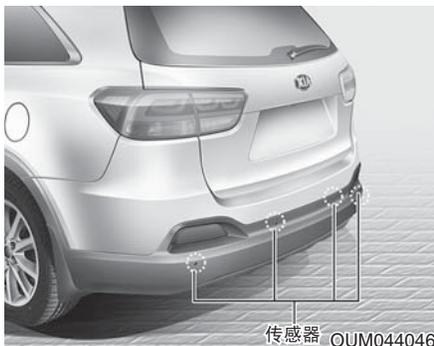
在倒车过程中，后驻车辅助系统向驾驶员提供帮助。如果检测到在车辆后方120cm 的距离内有物体存在，该系统会发出警告音。该系统是一个辅助系统而且既不能预测也不能因为配备了该系统而放松警惕，检测范围和可检测的物体受后部传感器的限制。无论何时进行倒车操作，都应像没有配备后驻车辅助系统一样多加注意车后的物体。
