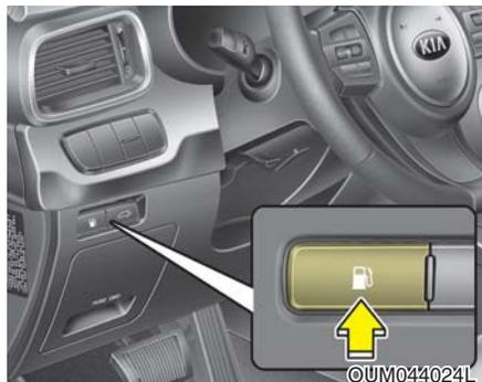
必须通过按下燃油加油口门开启按钮从车内打开燃油加油口门。
