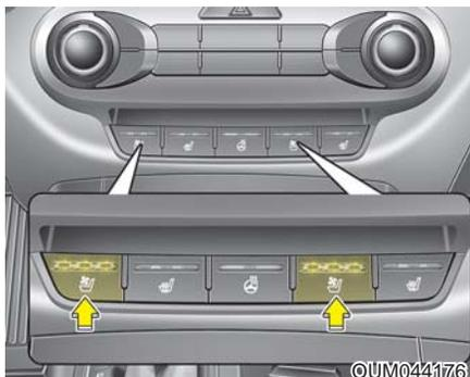
座椅的温度设置根据开关位置变化。
