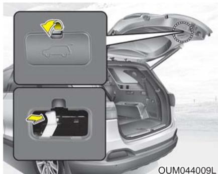
在您车辆的后备箱门底部配备了紧急后备箱门安全释放杆。有人不慎被锁在行李间内时，可通过下列操作打开后备箱门。
