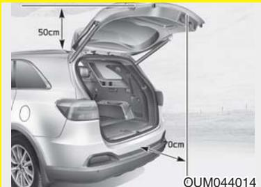
操作电动后备箱门(或智能后备箱门)前, 确定电动后备箱门(或智能后备箱门)移动路径上没有人或物品。如果被电动后备箱门(或智能后备箱门)冲撞, 会导致严重伤害、损坏车辆或损坏周围物品。
