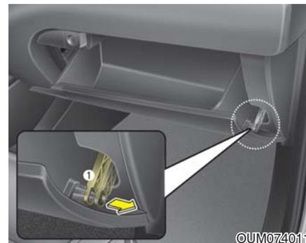
2. 在手套箱打开状态，拉支撑带(1)。
