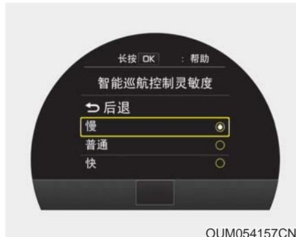
为了维持设定距离，车辆跟随前车行驶时，可调整车速灵敏度。转至用户设置模式(驾驶辅助)并选择SCC(智能巡航控制)系统。您根据您的喜好，可以任意选择三个阶段中的一个。
