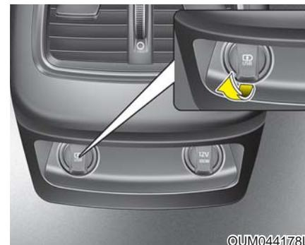
USB充电器可以使用USB连接线给小型电子设备的电池进行充电。发动机启动/停止按钮置于ACC/ON/START位置时，可给电子设备进行充电。
