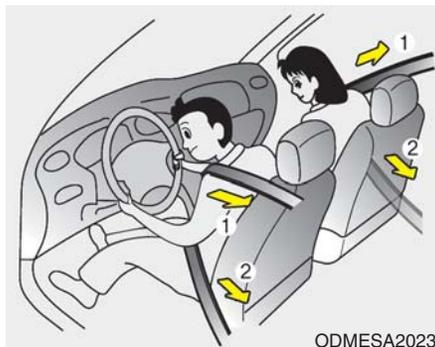
您车辆配备了驾驶席和助手席安全带拉紧器(卷带器拉紧器和EFD(紧急锁紧机构))。
