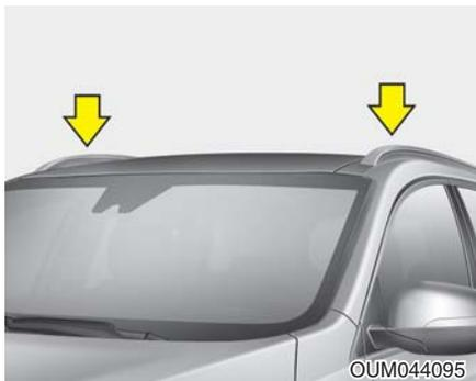
如果您的车辆有车顶行李架，您可以在车顶上运载物品。可从Kia授权经销商或其它合格维修站获取在车辆上安装车顶行李架所需的横杆和固定部件。
