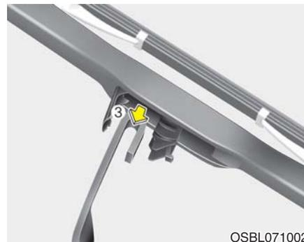
4. 向下推雨刮器臂(3)，并按拆卸的反顺序安装新雨刮器刮片总成。
