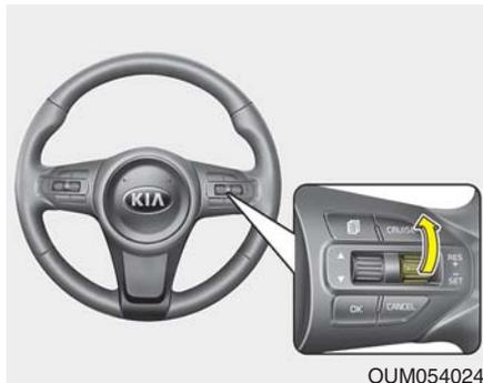
如果利用除了巡航(CRUISE)/按钮外的方式解除了巡航速度控制，巡航控制系统仍处于工作状态。此时操作RES+开关时，会自动恢复到最近设定的巡航速度控制。
