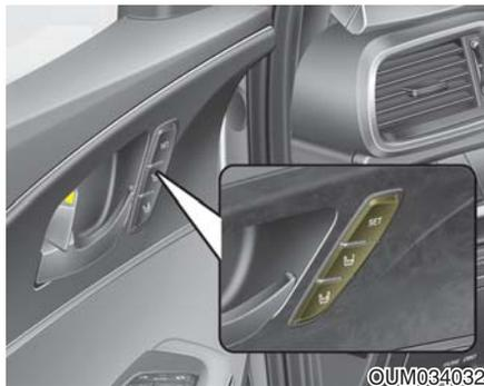
在车辆上提供了驾驶席位置记忆系统, 借助简单的按钮操作可以存储和恢复驾驶席座椅位置和室外后视镜位置。通过存储理想位置到系统记忆装置中, 不同驾驶员可根据他们的驾驶习惯进行位置重置。如果分离了蓄电池, 会清除位置记忆, 应还原系统里的驾驶位置。
