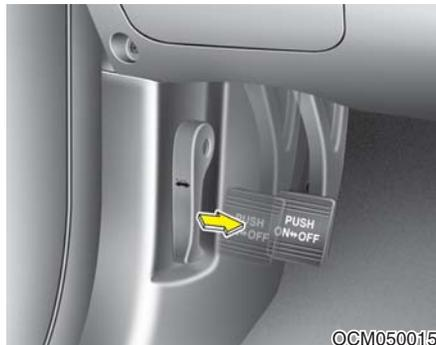
检查用30kg (66 lb, 294 N)的力踩下驻车制动踏板时驻车制动踏板的行程是否在规定范围内，且只用驻车制动装置就能将在相当陡的斜坡上的车辆牢固地固定住。如果行程大于或小于规格，请Kia授权经销商维护系统。
