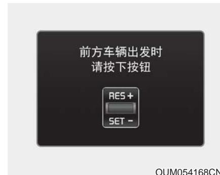
在车流中，如果前方车辆停止，您的车辆也停车。同样，如果前车开始移动，您的车辆也开始起步。但如果车辆停止时间超过3秒钟，您必须踩下加速踏板或上/下移动操纵杆(到RES+或SET-)以开始驾驶。
