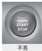
要停止发动机(起动/运转位置)或切断车辆电源(ON位置)，变速杆在“P(驻车)”位置状态按下发动机起动/停止按钮。变速杆不在“P(驻车)”位置状态按下发动机起动/停止按钮时，发动机起动/停止按钮不转到“OFF”位置，而转到“ACC”位置。
