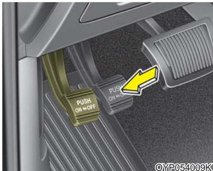
要设置驻车制动装置，使用脚制动器充分且用力地向下踩驻车制动踏板。
