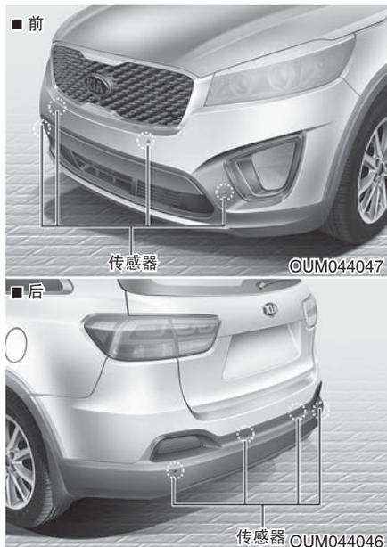
在倒车过程中，驻车辅助系统向驾驶员提供帮助。如果检测到在车辆前方100cm、车辆后方120cm(47in.)的距离内有物体存在，该系统会发出警告音。
