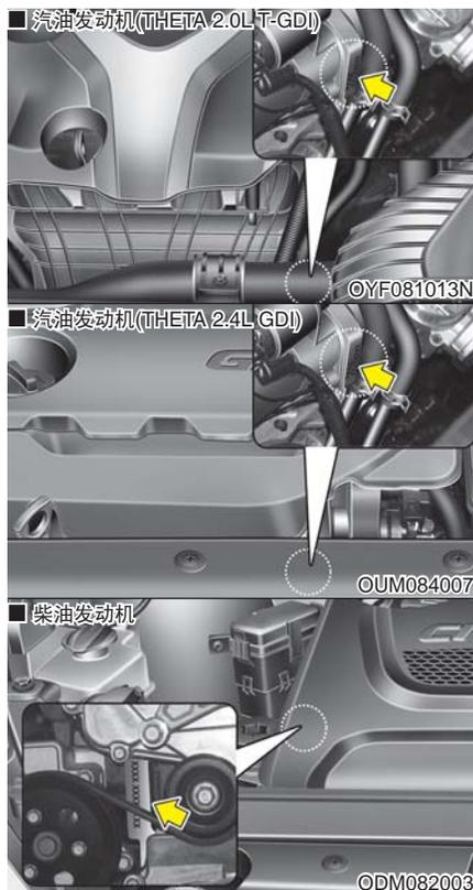
如图所示，发动机号码印在发动机缸体上。
