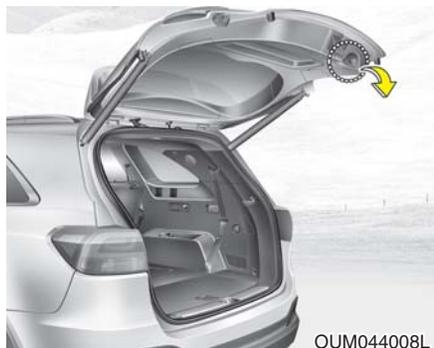
放低并牢固按压后备箱门，确定后备箱门牢固锁住。
