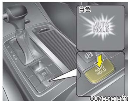
1. 在驾驶席车门、发动机罩和行李箱盖关闭状态，佩戴好驾驶席安全带或踩下制动踏板，按下自动固定按钮。白色AUTO HOLD(自动固定)指示灯亮，系统进入准备位置。
