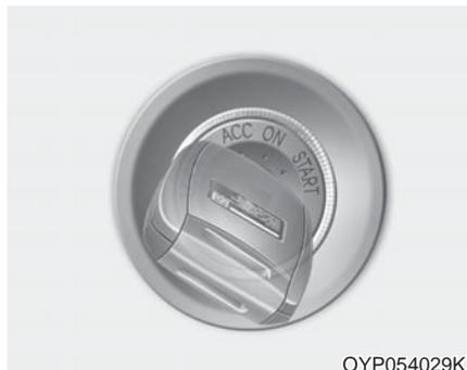
锁住方向盘可防盗。只有点火开关在LOCK位置时才可以拔出点火开关钥匙。
