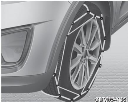
由于子午线轮胎侧围较薄，如果在其上装配某些类型的防滑链，可能会损坏轮胎。因此，使用推荐的防滑链代替雪地防滑链。不要在配备铝制车轮的车辆上安装轮胎防滑链，因为雪地防滑链会损坏这种车轮。如果必须安装雪地防滑链，请使用厚度不超过12mm的钢丝型防滑链。由于防滑链使用不当而导致的车辆损坏不在车辆制造商的保修范围内。
