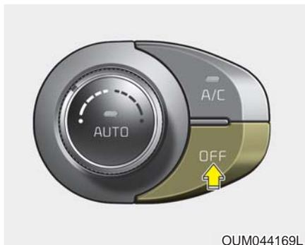
按下前鼓风机OFF按钮可停止前空调控制系统。但是，在点火开关ON时您仍能操作通风模式和内外气选择按钮。
