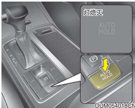
要解除自动固定操作，请按下自动固定开关。自动固定指示灯熄灭。
