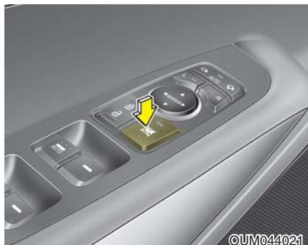
驾驶员可通过将电动门窗锁止开关按到锁止位置(按下)来停用后座乘员车门上的电动门窗开关。
