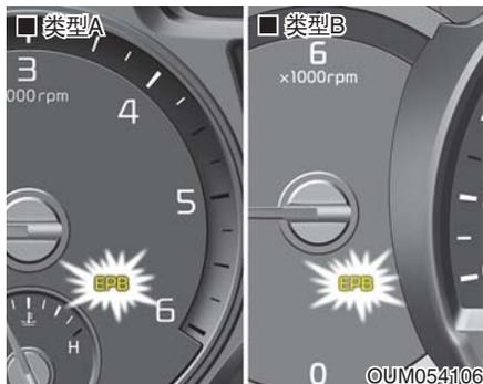
此警告灯在发动机起动/停止按钮转至ON位置时亮, 如果系统正常工作, 警告灯在约3秒内熄灭。
