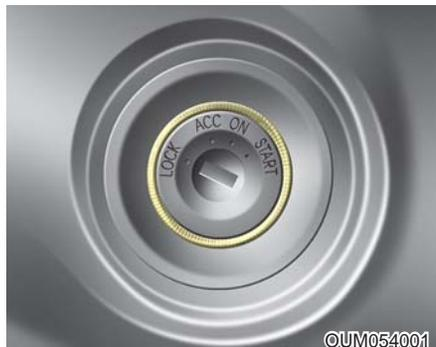
点火开关不在ON位置时，无论何时打开车门，都会给点火开关照明以便为您提供便利。此灯在将点火开关置于ON位置时立即熄灭，也在关闭车门约 30 秒后熄灭。
