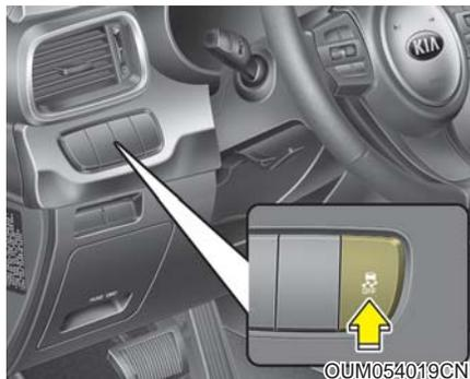
电子稳定控制(ESC)系统在车辆转弯过程中稳定车辆。当您的车辆转弯时ESC系统检测转向意图以及车辆实际转向轨迹。当实际转向轨迹与您的转向意图不相符时ESC系统控制特定轮的制动压力并介入发动机控制系统，使车辆稳定行驶。
