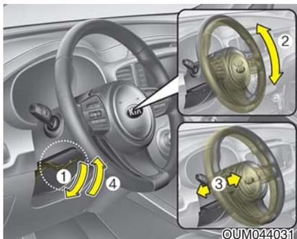
要变更方向盘角度，可以向下拉锁止释放杆(1)，调整方向盘到理想的角度(2)和理想的位置(3)，然后向上拉锁止释放杆(4)，把方向盘锁在适当位置。驾驶前一定要调整方向盘到理想的位置。
