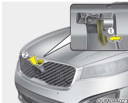
2. 来到车辆前方，稍微举升发动机罩，将第二挂钩(1)推向左侧并提起发动机罩(2)。
