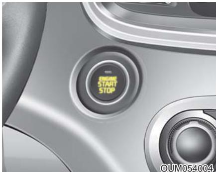
无论何时打开前车门，发动机起动/停止按钮照明灯亮，为您提供方便。关闭车门时，此灯在约30秒后熄灭。它也在发动机起动/停止按钮位于ON位置时立即熄灭。
