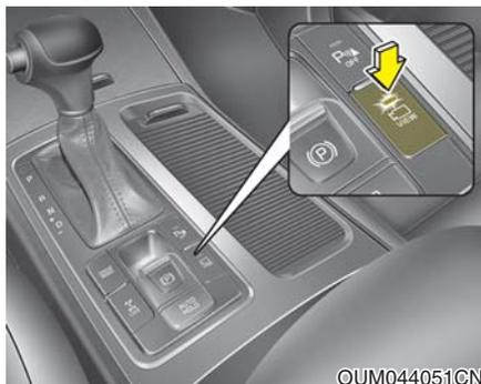
此系统为驻车支持系统，驻车时在显示器上显示周围环境情况。将按钮推到[ON]位置时，此系统工作。要关闭此系统，再次按下按钮。
