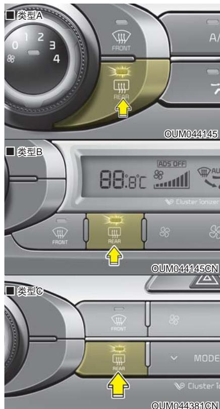
发动机运转期间除霜器加热车窗从而除去后车窗上的霜、雾和薄冰。要启动后车窗除霜器，可以按中央仪表开关板上的后车窗除霜按钮。除霜器ON时后车窗除霜按钮上的指示灯亮。
