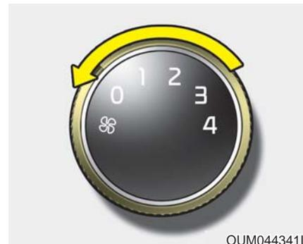
要关闭鼓风机，将鼓风机速度控制钮转到“0”位置。
