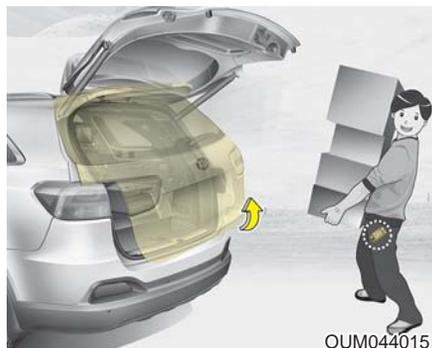
车辆配备智能钥匙系统时，利用智能后备箱门系统可在不碰触启动开关的状态打开后备箱门。
