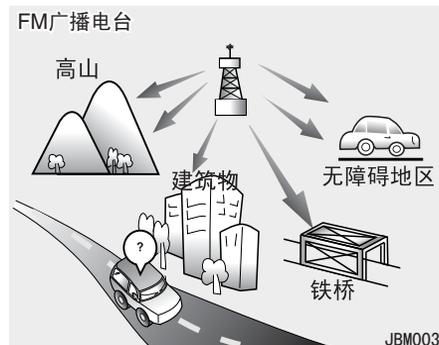
FM广播信号是以高频率传送的，它不能弯曲地追随地球曲面。因此，FM广播信号通常在离信号发射塔较近的地方就开始时强时弱。同样，FM信号易受高楼、高山或其它阻塞物的影响。这些原因可导致声音不清晰，使您认为您的收音机存在故障。下列情况属正常现象，并不代表收音机发生故障：
