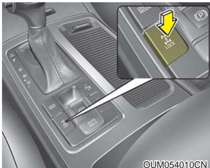
能将发动机动力传输到所有的前后轮，以获得最大牵引力。在光滑路面、泥地、湿地或路面覆盖积雪等需要额外牵引力的路面上驾驶车辆时，AWD非常有用。这些车辆不是设计用于挑战野外驾驶目的。在已有的未铺砌的道路或小路上，可以偶尔使用越野功能。当越野驾驶时，司机应小心的把速度减少至不超过路况允许的安全驾驶速度，这点十分重要。通常，越野路况比普通路况提供更小的牵引力和有效刹车。
