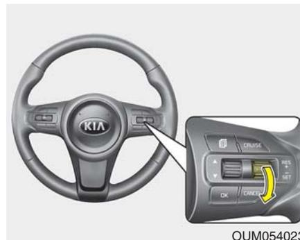
3. 向下移动操纵杆(到SET-(设定/减速)位置)并在到达理想速度时释放，巡航控制设定指示灯亮。同时释放加速踏板，车辆会自动保持此理想速度。
