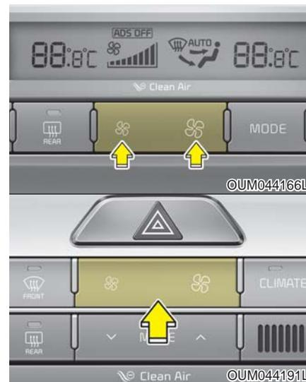
通过按下鼓风机速度控制按钮,可把鼓风机速度设定到理想速度。鼓风机速度越快,送气量越多。按下OFF按钮可关闭鼓风机。
