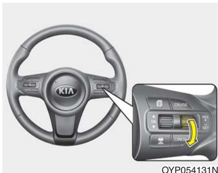
3. 向下移动开关杆(向SET-方向)，并在到达理想速度时释放。LCD显示屏上的设定速度和与前车之间距离亮。
