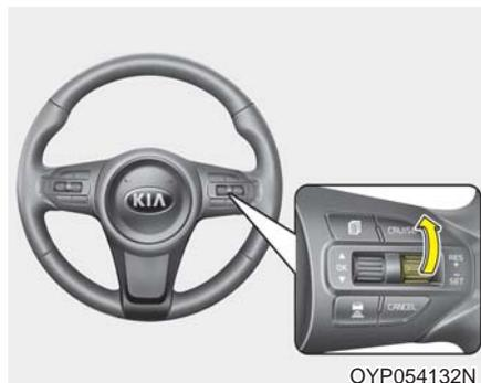
如果利用除了巡航(CRUISE)按钮外的方式解除巡航速度控制，巡航控制系统仍处于工作状态。操作操纵杆上推(到RES+)时，会自动恢复巡航速度控制。
