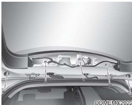
4. 拧下固定螺母并拆卸扰流板。
