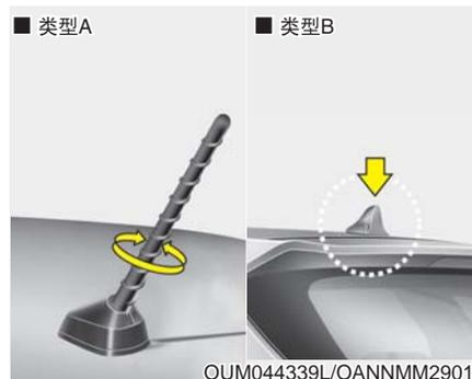
您可以使用车顶天线接收AM和FM广播信号，这种天线是可拆卸型。要拆卸天线，逆时针转动天线；要安装天线，顺时针转动天线。
