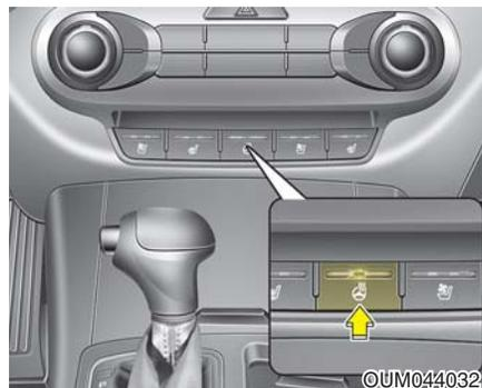
点火开关在ON位置时，按下方向盘加热按钮加热方向盘。此时按钮上的指示灯亮，并通过LCD显示器告知。
