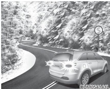
在转弯时避免踩制动或换档，尤其是雨天或路湿时。尽量在轻微加速的情况下以平稳速度转弯。若遵循这些建议，您可以把轮胎磨损率减到最低。
