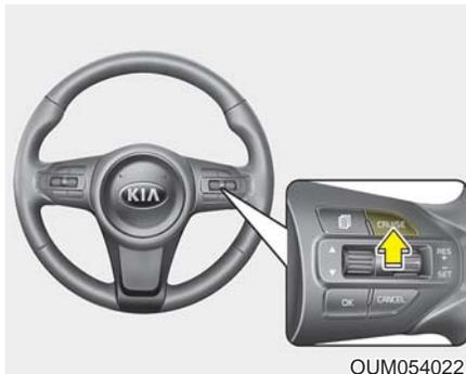
1. 按下方向盘上的“CRUISE”开关接通系统。仪表盘上的巡航指示灯亮。
