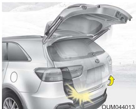
在电动打开和关闭操作中，如果电动后备箱门操作受到物体或身体某部分的阻碍，电动后备箱门会检测到阻力。
