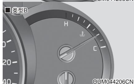
该仪表显示点火开关或发动机启动/停止按钮置于ON位置时发动机冷却水的温度。
