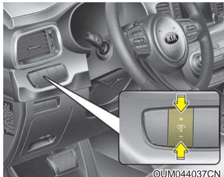
在点火开关或发动机启动/停止按钮在ON位置，或尾灯开关在ON位置时，按动照明灯控制按钮(“+”或“-”)可以改变仪表盘照明灯的亮度。
