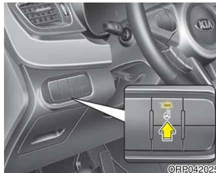
点火开关在ON位置时，按下方向盘加热按钮加热方向盘。
