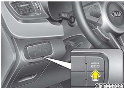
主动ECO功能通过控制发动机和变速器帮助提高燃油效率。但驾驶员的驾驶习惯和路况可改变燃油效率。
