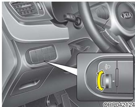
要根据乘员数及行李区的负载重量调整大灯水平光束高度，旋转大灯水平光束高度调整开关。
