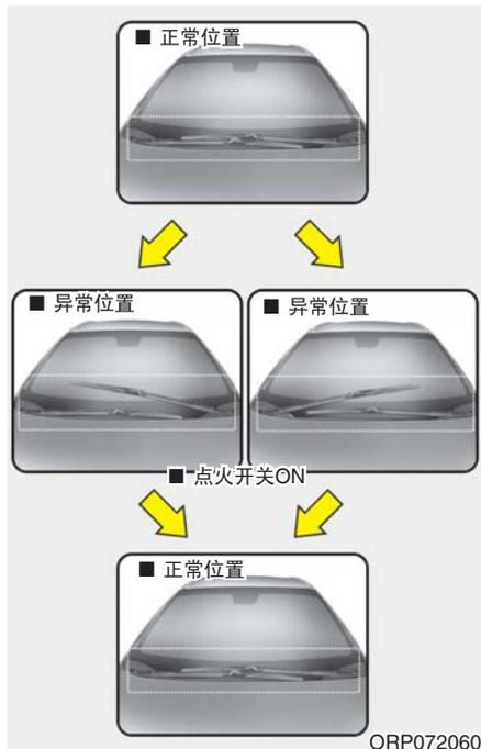
雨刮器刮片不在正常位置时，将点火开关置于ON位置。雨刮器刮片会返回到正常位置。
