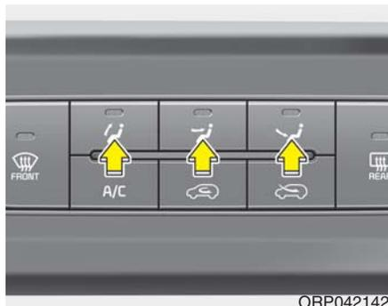
通风模式选择按钮控制经由通风系统流入的气流方向。
