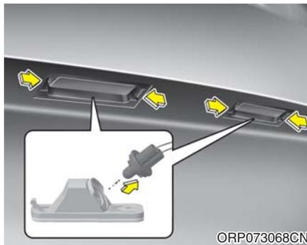
1. 用十字头螺丝刀拧下灯罩固定螺钉。
