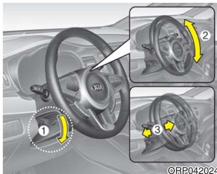
要变更方向盘角度，可以向下拉锁止释放杆(1)，调整方向盘到理想角度(2)和高度(3)，然后向上拉锁止释放杆把方向盘锁定在适当位置。驾驶前，一定要调整方向盘到理想位置。
