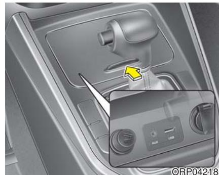
您可使用AUX插座连接外部音频设备，使用USB插座可以插入USB和iPod。
