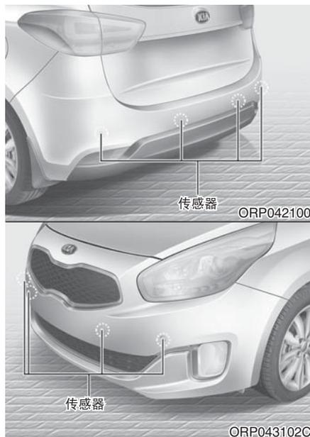
在倒车过程中，驻车辅助系统向驾驶员提供帮助。如果检测到在车辆前方100cm、车辆后方120cm的距离内有物体存在，该系统会发出警告音。
