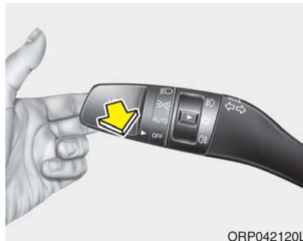
向您的方向拉动并松开灯光控制杆，大灯闪光，灯光控制杆返回到正常位置。使用闪光功能时不需要接通大灯开关。
