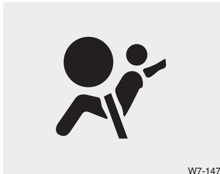
仪表盘上的空气囊警告灯用于警告驾驶员空气囊-辅助保护系统(SRS)可能有故障。当点火开关ON时,警告灯亮约6秒钟,然后熄灭。
