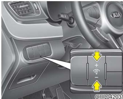
在点火开关或发动机起动/停止按钮在ON位置或尾灯开关在ON位置时，按下照明控制按钮("+或"-)改变仪表盘照明灯亮度。
