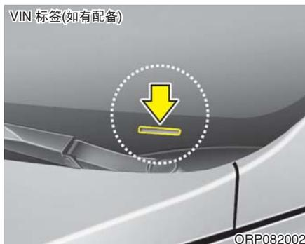
在粘贴在仪表盘罩上部的铭牌上也有车架号(VIN)。铭牌上的车架号通过挡风玻璃在外部很容易看到。
