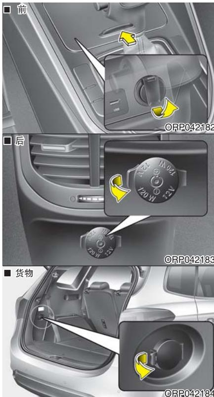
电源插座用于给手机或其它与车上的电气系统一起工作的装备提供电源。发动机运转时此插座可获得10安培以下的电流。
