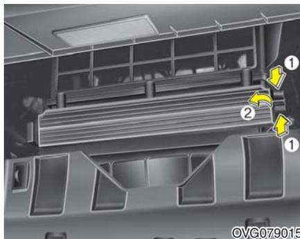
3. 在按下盖的右侧锁状态拆卸盖，并拆卸空控制空气滤清器。
