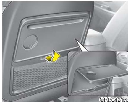
座椅靠背桌位于前座椅背部。旋转座椅靠背桌到水平位置，第2排座椅上的乘员可使用座椅靠背桌。
