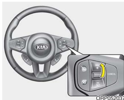
如果使用RES+按钮以外的方式解除了巡航速度控制，巡航控制系统仍处于工作状态，推RES+开关时，会自动恢复到最近设定的巡航速度。
