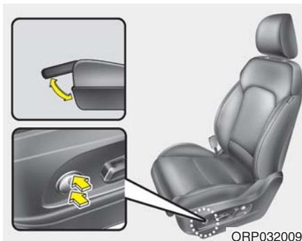
上下推拉控制开关移动座垫延伸板到理想位置。一旦座垫延伸板到达理想位置，释放开关。
