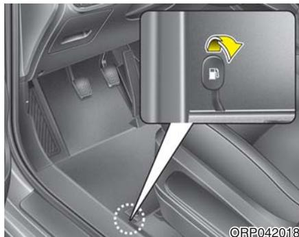
必须通过拉起驾驶席座椅前底板上的燃油加油口门开启杆从车内打开燃油加油口门。
