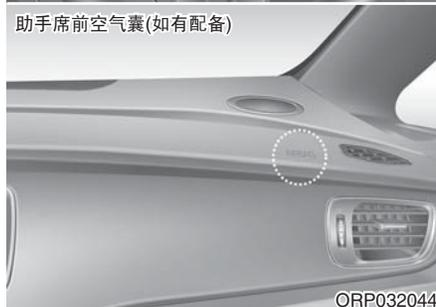
您的车辆上配备了辅助安全(空气囊)系统,并在驾驶席和助手席座椅上安装了胯部/肩部安全带。系统标志为字母“**AIR BAG**”,刻印在方向盘中央空气囊装饰盖和助手席前手套箱上方的仪表板上。
