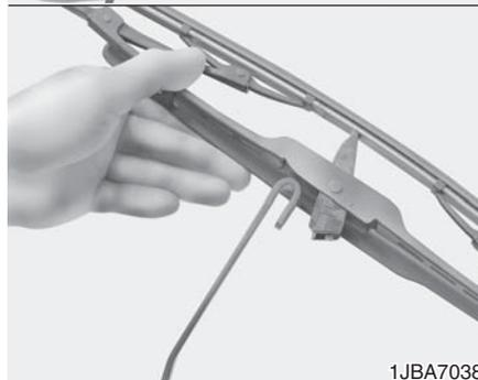
2. 压缩夹并向下滑动雨刮器刮片总成。
