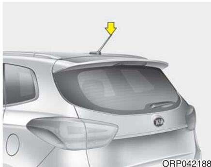
您可以使用车顶天线接收AM和FM广播信号，这种天线是可拆卸型。要拆卸天线，逆时针转动天线；要安装天线，顺时针转动天线。
