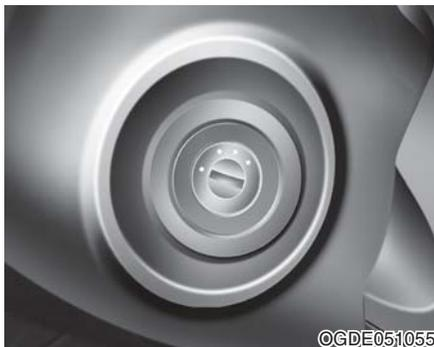
点火开关不在ON位置时，无论何时打开车门，都会给点火开关照明以便为您提供便利。此灯在将点火开关置于ON位置时立即熄灭，也在关闭车门约30秒后熄灭。
