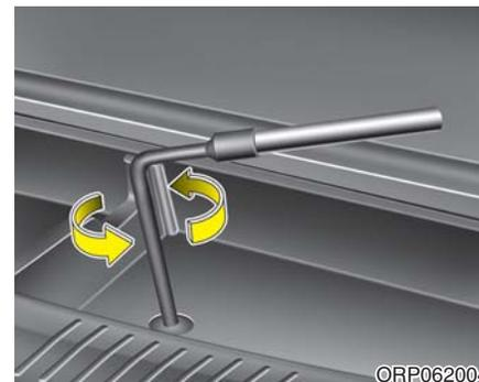
3. 连接套筒和轮毂带耳螺母扳手。
