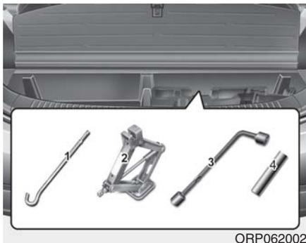
千斤顶、千斤顶手柄、车轮螺母扳手储存在行李舱内。
