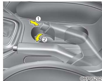
要释放驻车制动装置，首先踩下制动踏板，然后轻轻拉起驻车制动操纵杆，按下释放按钮(1)并在按下按钮的过程中放下驻车制动操纵杆(2)。
