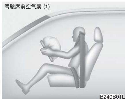
空气囊总成位于方向盘的中央和杂物箱上方的助手席前仪表盘罩内。SRSCM检测到车辆的前碰撞严重性达到一定程度时，会自动展开前空气囊。
