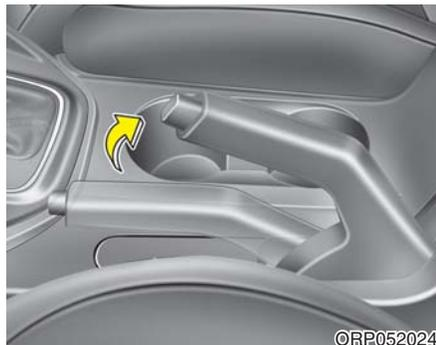
要啮合驻车制动器，首先踩下制动踏板，在不按下释放按钮的情况下尽量向上拉驻车制动杆。另外，在斜坡上驻车时一定要将自动变速器的变速杆置于P(驻车)位置。
