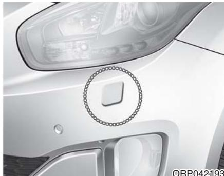
如果车辆配备大灯喷水器，在您操纵挡风玻璃喷水器时大灯喷水器也同时运转。大灯喷水器在大灯开关位于第一或第二位置，并点火开关或发动机起动/停止按钮位于ON位置时工作。
