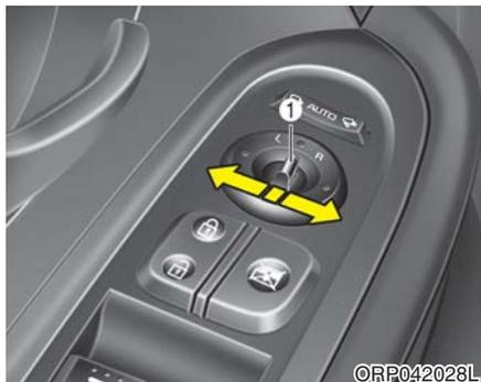
用电动远程控制后视镜开关可以调整左右室外后视镜的位置。要调整任意后视镜的位置，可以把选择杆(1)移到R(右)或L(左)来选择右侧后视镜或左侧后视镜，然后按下后视镜调整控制开关上的对应位置上、下、左、右调整后视镜位置。
