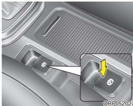
要释放EPB(电控驻车制动器)，在下列条件下按下EPB开关：
