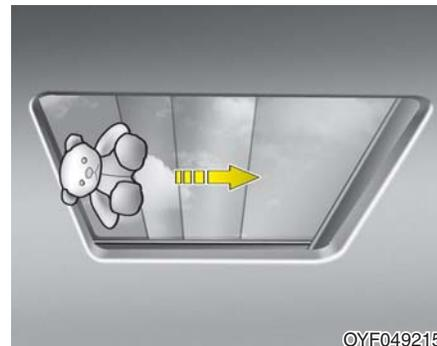
如果检测到物体或车身部件天窗玻璃或遮阳板自动关闭时，它将朝向相反的方向并停止。
