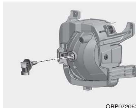
4. 逆时针转动灯座直到灯座上的舌片对正壳上的导槽即可从壳上拆下灯座。
