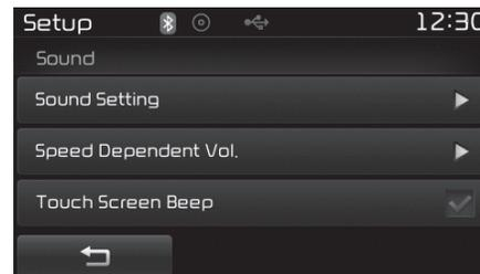
使用此功能打开/关闭触摸屏哔哔声。
