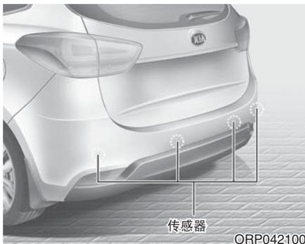
在倒车过程中，后驻车辅助系统向驾驶员提供帮助。如果检测到在车辆后方120cm的距离内有物体存在，该系统会发出警告音。该系统是一个辅助系统而且既不能预测也不能因为配备了该系统而放松警惕，
