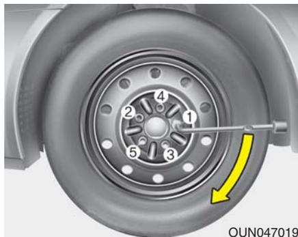
然后按照图示顺序拧紧车轮螺母。确认套筒完全套上螺母。切勿站在扳手的把手上或在扳手的把手上使用一个延长管。需紧固车轮的所有螺母，并再次检查所有螺母的紧固情况。顺着车轮拧紧每个螺母，直到它们全部被拧紧为止。
