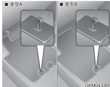
在前地板地毯上铺上底板垫时，确保底板垫挂在您车辆的底板垫固定钩上。这能防止底板垫向前滑动。
