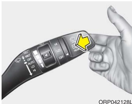
在OFF位置，朝您所在方向轻拉开关杆，向挡风玻璃喷射清洗液并运转雨刮器1-3周期。
