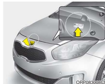
制冷剂标签位于发动机罩内侧板上。
