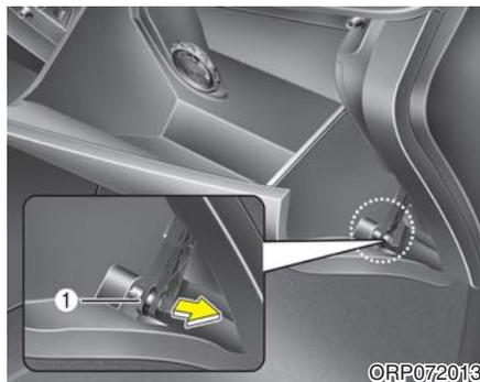
2. 打开手套箱，拆卸手套箱支撑带(1)。
