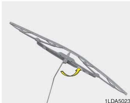
1. 升高雨刮器臂并转动雨刮器刮片总成以露出塑料锁夹。
