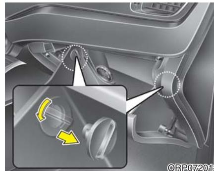
1. 在手套箱打开状态，拆卸手套箱两侧的止动块。
