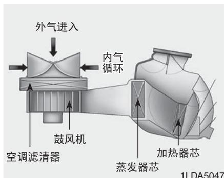
空调滤清器安装在杂物箱后面，过滤通过暖风和空调系统进入车内的灰尘和其它污染物。如果灰尘和其它污染物积聚在滤清器内超过一段时间，通过通风口流入的空气量下降，导致即使选择外气(新鲜空气)进入位置仍在挡风玻璃内侧积聚湿气。如果发生这种情况，由授权的经销商更换空调滤清器。
