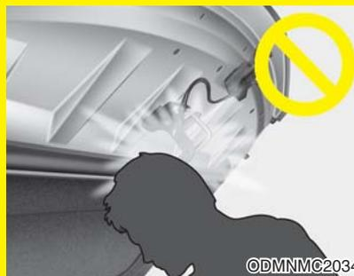
检查发动机室时，请确定位于发动机罩内侧的发动机罩安全挂钩不会伤及您的头部。
