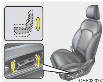
1. 向上拉起控制开关前部可升高座垫前部，向下压下控制开关前部可降低座垫前部。
