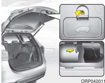
您车辆配备紧急后备箱门安全释放杆(位于后备箱门的底部)。
