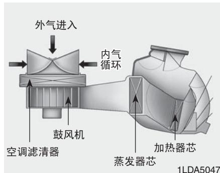
空调滤清器安装在杂物箱后面，过滤通过暖风和空调系统进入车内的灰尘和其它污染物。如果灰尘和其它污染物积聚在滤清器内超过一段时间，通过通风口流入的空气量下降，导致即使选择外气(新鲜空气)进入位置仍在挡风玻璃内侧积聚湿气。如果发生这种情况，由授权的Kia经销商更换空调滤清器。
