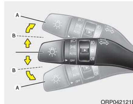
要使用转向信号灯功能，必须将点火开关置于ON位置。要打开转向信号灯，可以上下移动控制杆(A)。仪表板上的绿色箭头指示灯指示正使用的转向信号。
