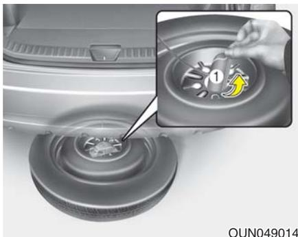
5. 备胎到达地面后，持续逆时针转动扳手并向外拉出备胎。禁止过度转动扳手，否则会损坏备胎托架。
