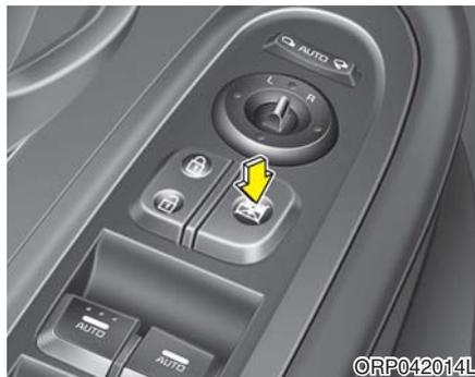
驾驶员可通过将电动门窗锁止开关按到锁止位置(按下), 停用后车门上的电动门窗开关。
