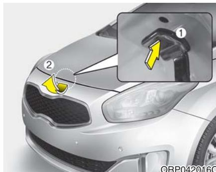
2. 来到车辆前方，稍微举升发动机罩，并拉动位于发动机罩中央内侧的第二挂钩(1)，然后举起发动机罩(2)打开。
