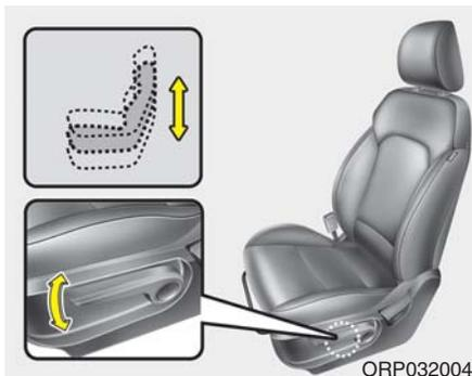
可通过上下推拉操纵杆调整座垫高度。
