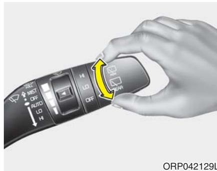
后窗雨刮器和喷水器开关位于雨刮器和喷水器开关杆的末端。将开关转至理想位置后操作雨刮器和喷水器。
