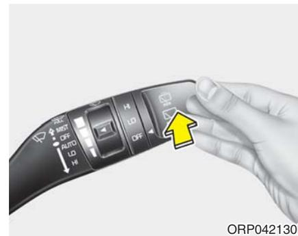
朝远离您的方向推开关杆，向后挡风玻璃喷射清洗液并运转雨刮器1-3周期。喷水器及雨刮器持续工作，直到您释放开关杆为止。
