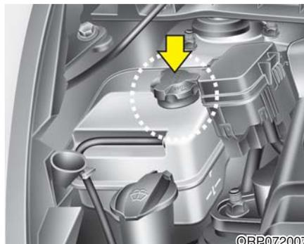
检查所有冷却系统软管和加热器软管的连接部位和状态，若有膨胀或变质则更换。应在发动机冷却时将冷却水箱中的冷却水量添加到冷却水箱侧面的F(MAX)和L(MIN)标记之间。
