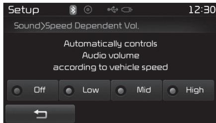
根据车速自动控制音量级。可以选择 OFF/低/中/高 (Off/Low/Mid/High) 设置车速感应音量。
