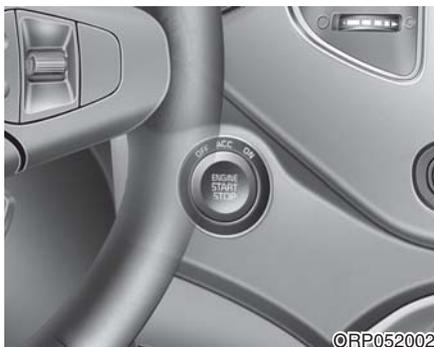
无论何时打开前车门，发动机起动/停止按钮照明灯亮，为您提供方便。关闭车门时，此灯在约30秒后熄灭。防盗警报系统进入警戒状态时，此灯立即熄灭。
