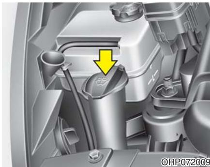
检查喷水器液储液箱中的液位，若有需要则补充。如果没有喷水器液亦可使用普通水。然而在寒冷天气下最好使用有防冻性能的挡风玻璃喷水器液溶剂以防结冰。
