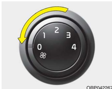
要关闭鼓风机，将鼓风机速度控制钮转到“0”位置。
