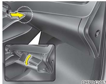
要打开手套箱，按下按钮，手套箱会自动打开。使用后请关闭手套箱。
