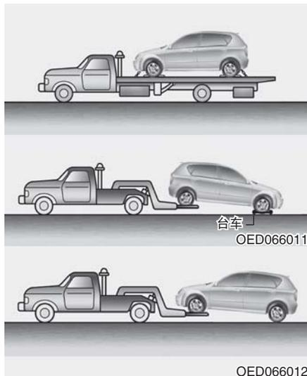
需要紧急拖吊时，我们建议您将此项工作交由授权的Kia经销商或商业拖吊卡车服务公司来进行。唯有使用正确的举升和拖吊程序才能避免损坏车辆，推荐您使用车轮台车或平板装置。
