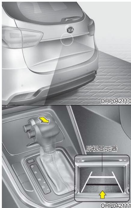
点火开关置于ON位置、变速杆置于R(倒档)位置状态倒车灯亮时, 后视摄像头启动。
