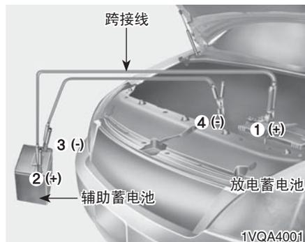
按编号顺序连接导线，按相反顺序分离导线。
