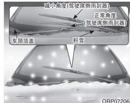
由于车颈顶盖上的积雪限制助手席侧雨刮器刮片运转时，减小驾驶席侧雨刮器刮片的操作角度，以免两个雨刮器刮片之间发生碰撞。
