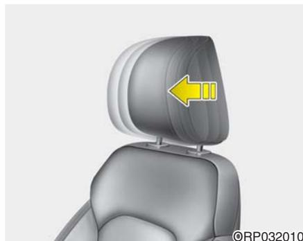
头枕前后方向有4个不同位置，可以向前拉头枕到4个位置中的理想位置。要调整头枕到最后位置，向前拉头枕到最前位置后释放即可。调整头枕位置使其正确支撑乘员的头部和颈部。
