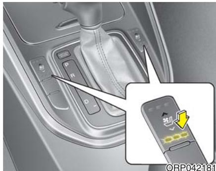
提供了通风座椅，在炎热天气里通过座椅和座椅靠背表面上的小通风口鼓风机来冷却驾驶席座椅。
