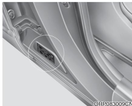
车辆合格证标签位于助手席侧中央立柱上，标有车辆识别码(VIN)。
