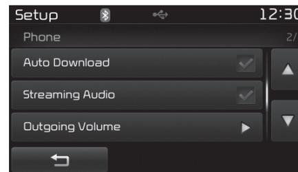
一旦连接Bluetooth® Wireless Technology手机，使用此功能自动下载手机联系人信息。
