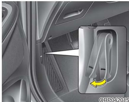
1. 拉释放杆使发动机罩开锁。发动机罩会轻微砰然打开。
