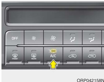
按一下A/C按钮可打开空调系统(指示灯亮)。再按一下A/C按钮可关闭空调系统。
