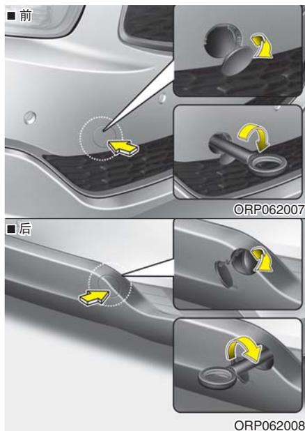
1. 打开后备箱门，并从工具箱中拆卸拖吊挂钩。
