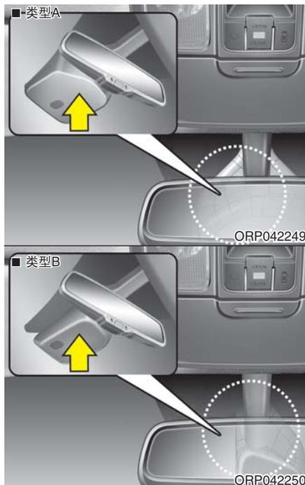
自动除雾系统通过自动检测挡风玻璃内侧的湿气降低挡风玻璃内侧的生雾可能性。
