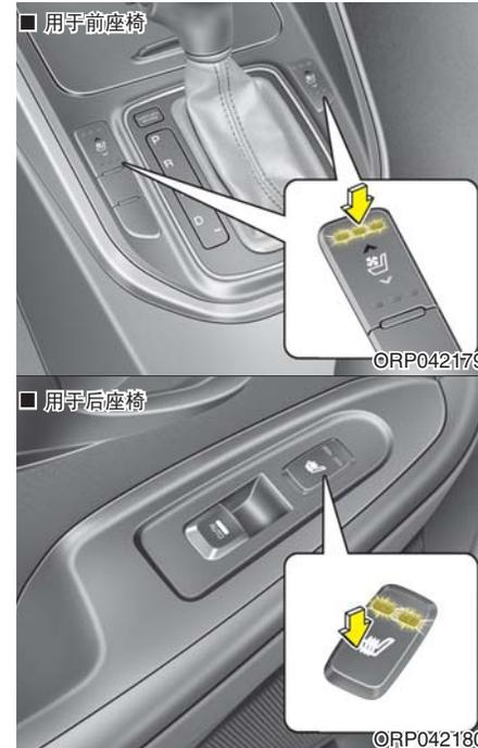
座椅加热器在寒冷季节加热前座椅。
