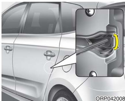
如果不能使用电动门锁操纵开关进行电动操作，唯一的解决方法是通过车门外侧钥匙孔用机械钥匙闭锁车门。
