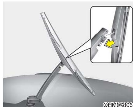
2. 把新雨刮器刮片总成的中央部分插入雨刮器臂的导槽内直到伴随着咔嚓声锁定即安装新雨刮器刮片总成。
