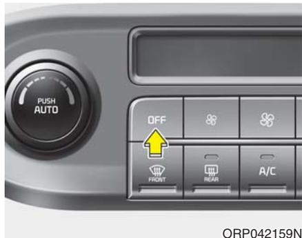
按下OFF按钮即可关闭空调控制系统。但是，在点火开关ON时您仍能操作通风模式和内外气选择按钮。
