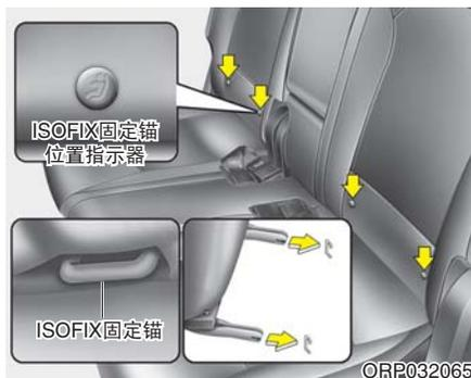
左右后座椅的靠背下部两侧都有ISOFIX符号。这些符号指示配备儿童保护座椅的下固定锚位置。
