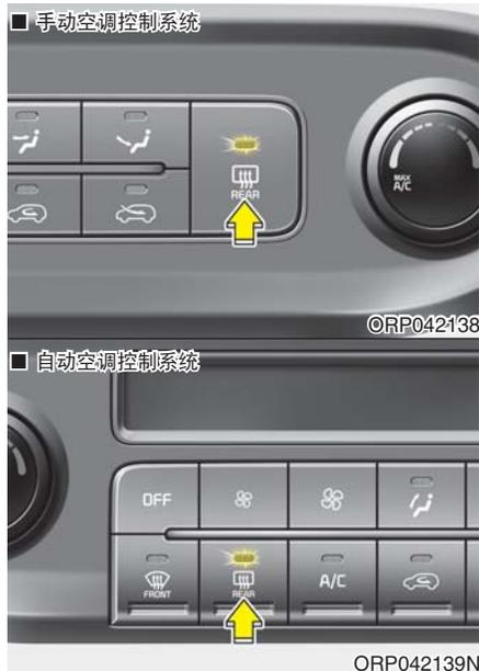
发动机运转期间除霜器加热后窗，从而除去后窗外部的霜、雾和薄冰。
