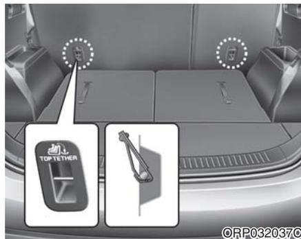
儿童保护座椅挂钩固定锚位于后座椅靠背后面。(第2排座椅)
