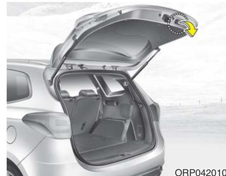
降低并稳固推动后备箱门。确定后备箱门牢固锁住。
