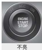
要起动发动机，变速杆在“P(驻车)”或“N(空档)”位置状态踩下制动踏板并按下发动机起动/停止按钮。为了您的安全，变速杆仅在“P(驻车)”或“N(空档)”位置状态起动发动机。
