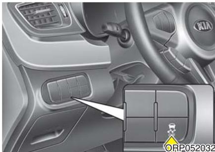
电子稳定控制(ESC)系统在车辆转弯过程中稳定车辆。当您的车辆转弯时ESC系统检测转向意图以及车辆实际转向轨迹。
