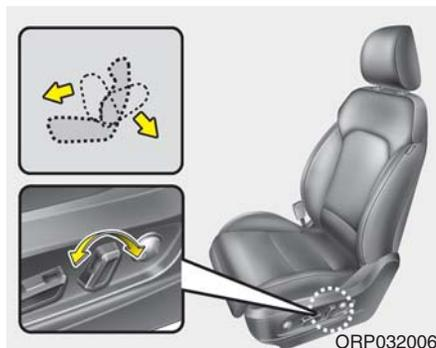
1. 前后推动控制开关，移动座椅靠背到理想角度。
