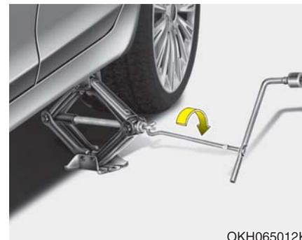
9. 把千斤顶手柄插入千斤顶并顺时针旋转。举升车辆直到轮胎离地，离地间隙约30mm。拆卸车轮螺母前，确认车辆平稳，并且没有滑动或移动的危险。
