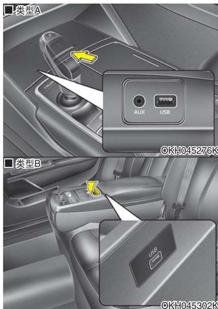
您可使用AUX接口连接音响播放设备，使用USB接口连接USB，iPod®也是如此。
