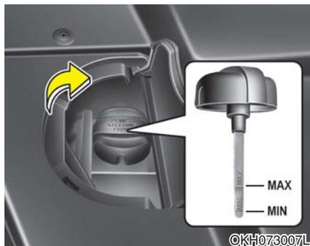
定期在车辆处于平坦地面的情况下检查动力转向油储油箱内的油量。常温下油量应在油尺的“MAX”和“MIN”标记之间。
