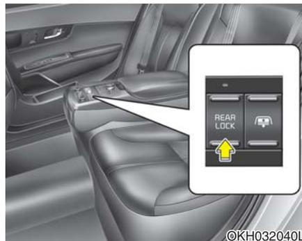
您可以使用后扶手上的后锁止(REAR LOCK)按钮或AVN(音频, 视频和导航)内的“系统设置”启用或禁用后座椅控制、后音响控制和空调控制。有关“系统设置”的详细信息请参考独立提供的手册。如果已通过AVN(音频, 视频和导航)设置禁用后控制按钮, 如果需要重新启用, 只能通过AVN(音频, 视频和导航)进行设置。
