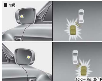
如果在系统检测范围内检测到车辆，室外后视镜和平视显示器上的警告灯亮。
