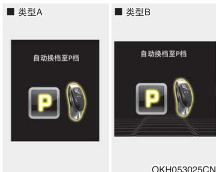
7. 当变速杆在[D]、[R]和[M]位置时下车，为了确保安全警告灯亮，并变速杆位置自动转换到[P]位置。
