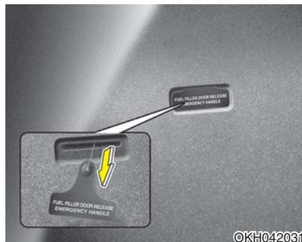
如果不能远距控制释放燃油加油口门，可以手动打开。轻轻向外拉把手即可。
