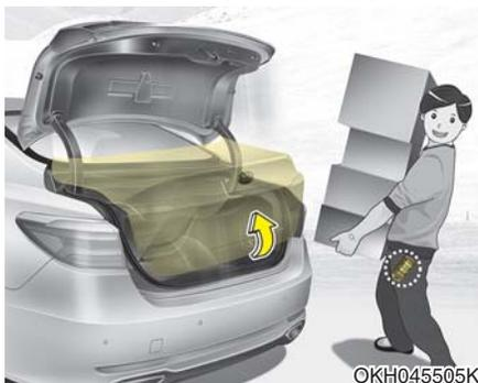
车辆配备智能钥匙系统时，利用智能行李箱盖系统在不碰触任何按钮的状态下可以自动打开行李箱盖。
