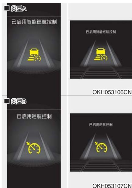
1. 接通智能巡航控制系统(巡航控制指示灯亮，但系统不启动)。
