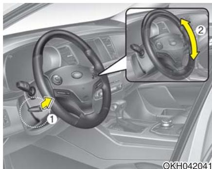
要调整方向盘角度，可以向下拉锁止释放杆(1)开锁，并调整方向盘到理想角度(2)，然后向上推锁止释放杆，把方向盘锁定在适当位置。一定要在驾驶前调整方向盘到理想位置。
