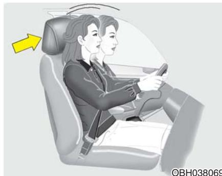
电子主动头枕设计为在碰撞传感器检测到后部冲击时触发头枕向前并向上移动。
