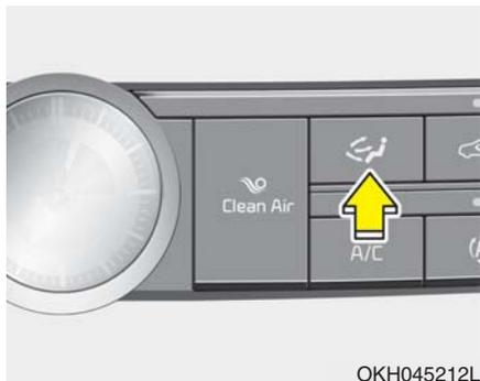
通风模式选择按钮控制从通风系统中流出的空气的方向。
