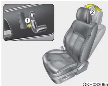
1. 使用倾斜控制开关(1)倾斜座椅靠背(2)。
