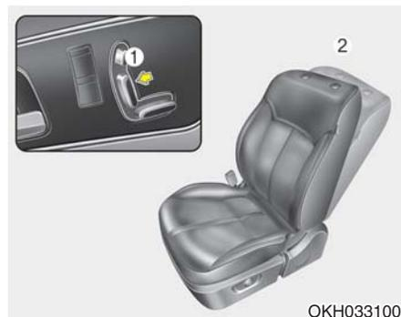
1. 操作倾斜控制开关(1)向后倾斜座椅靠背(2)。
