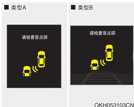
如果系统不正常工作，会显示此警告信息，并且开关上的指示灯熄灭。系统自动关闭。
