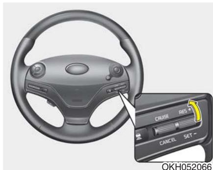
如果用操作巡航(CRUISE)开关杆外的方式解除巡航速度控制，巡航控制系统仍处于工作状态。
