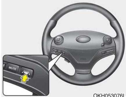
该系统使用前挡风玻璃处的传感器检测车道并在车辆偏离车道时向您发出警告。
