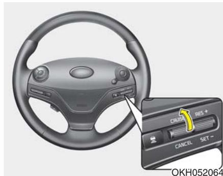
1. 向上移动开关杆(向巡航(CRUISE)方向), 巡航控制系统ON。
