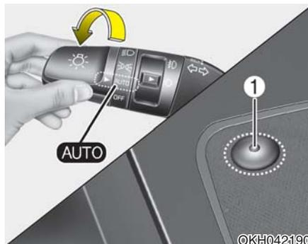
灯光开关在自动灯光位置时，尾灯及大灯将根据室外光线的亮度自动亮灭。
