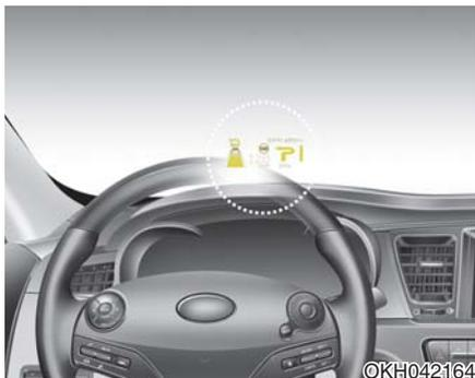
平视显示器是将仪表盘和导航信息投影到挡风玻璃上的透明显示器。
