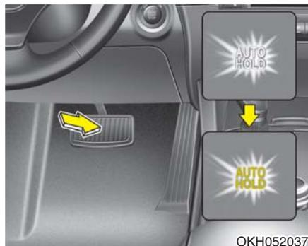
1. 在驾驶席车门、发动机罩和行李箱盖关闭状态下，佩戴好驾驶席安全带或踩下制动踏板，按下自动固定按钮。白色AUTO HOLD指示灯亮，系统进入预备状态。
