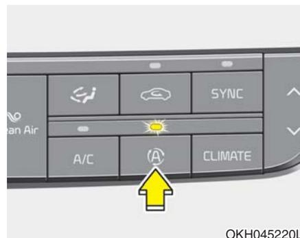
可以自动控制从室外进入的气流。按下按钮,启动空气净化控制系统。
