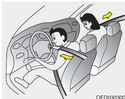
您的车辆配备了驾驶席和助手席安全带拉紧器。当发生正面碰撞事故，其严重性达到一定程度时安全带拉紧器与空气囊一起启动。如果车辆突然停车或乘员快速前倾，安全带卷带器会锁定。在一定程度的正面碰撞中，拉紧器启动并拉紧安全带，紧固乘员的身体。
