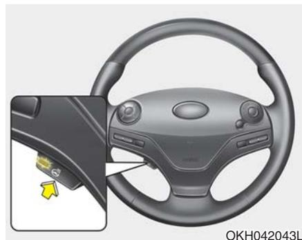
发动机起动/停止按钮在ON位置时，按下加热方向盘按钮可以加热方向盘，按钮上的指示灯亮。要切断加热方向盘操作，再次按下按钮即可，按钮上的指示灯熄灭。加热方向盘功能会在接通后30分钟自动切断。
