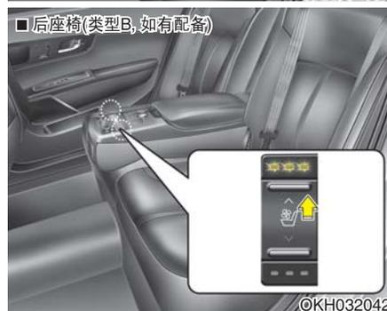
座椅加热器在寒冷季节加热座椅。在发动机启动/停止按钮位于“ON”位置的情况下，按下开关即可加热座椅。
