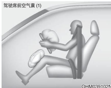
正面空气囊总成位于方向盘中央、助手席前手套箱上方的仪表板内和/或驾驶席护膝垫板内。SRSCM检测到车辆的前碰撞严重性达到一定程度时，会自动展开前空气囊。
