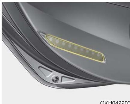
打开车门时门控灯亮，辅助乘客进出车辆。门控灯也用来在打开本车辆的车门时警告来往车辆。
