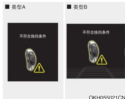
3. 如果高发动机转速或高车速不满足换挡条件，警告灯亮。降低发动机转速或车速时，换挡功能会恢复正常。
