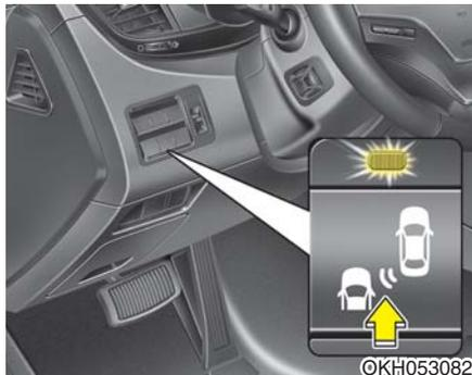
在发动机起动/停止按钮ON状态下，按下后侧方盲区警告系统(BSD)开关时，开关上的指示灯亮。
