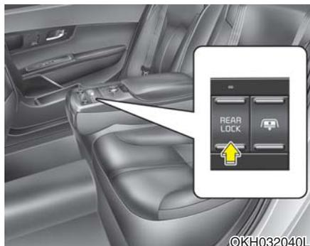
您可以使用后扶手上的后锁止(REAR LOCK)按钮或AVN(音频, 视频和导航)内的“系统设置”启用或禁用后座椅控制、后音响控制和空调控制。有关“系统设置”的详细信息请参考独立提供的手册。如果已通过AVN(音频, 视频和导航)设置禁用后控制按钮, 只能通过AVN(音频, 视频和导航)设置再次启用后控制按钮。
