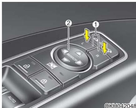
电动后视镜开关允许您电动调整左右室外后视镜的位置。要调整两后视镜中任意后视镜位置，可按下R或L按钮(1)选择“右”后视镜或“左”后视镜，然后按下后视镜调整控制按钮的对应位置(▲)，上下左右偏转调整选择的后视镜。
