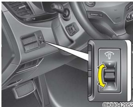
当发动机启动/停止按钮ON或尾灯ON时，按动照明控制按钮"+"或"-")可以调整仪表板照明灯的亮度。
