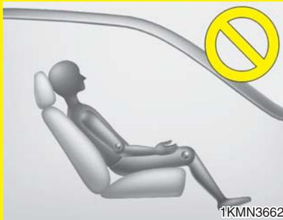
车辆行驶时如果前座椅靠背倾斜，则会导致人员在发生事故时受到严重或致命的伤害。如果前座椅倾斜，发生事故时乘客的臀部可能滑出腹部安全带，使未受保护的腹部受力较大，导致人员受到严重或致命内伤。车辆行驶时驾驶员必须建议助手席乘客保持座椅靠背在舒服的直立位置。
