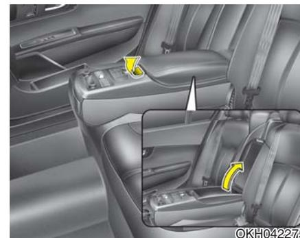
要打开后座椅储存箱，可以向上拉起控制杆。
