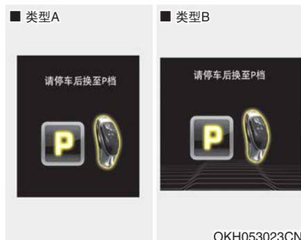
5. 如果在车速高的状态试图把变速杆移动到[P]位置，警告灯亮。应将车辆驻车在安全的地方后，把变速杆移动到[P]位置。
