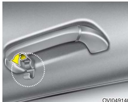
要使用吊架，向下拉吊架上部。
