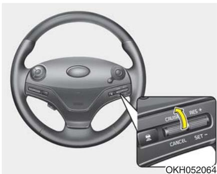
向上移动开关杆(向巡航(CRUISE)方向)。(仪表盘上的巡航控制(CRUISE)指示灯熄灭)
