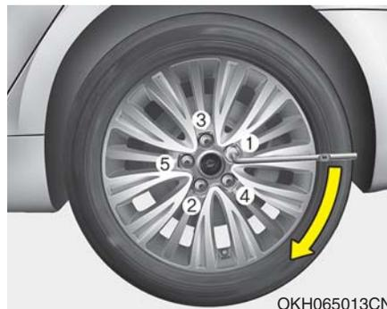
如图示定位扳手并拧紧车轮螺母。确认套筒完全套上螺母。切勿站在扳手的把手上或在扳手的把手上使用一个延长管。
