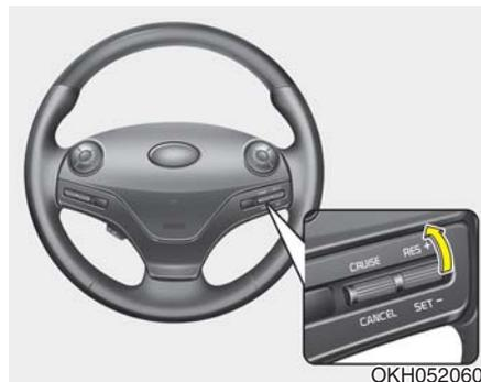
如果用巡航(CRUISE)开关杆操作外的方式解除巡航速度控制，巡航控制系统仍处于工作状态。向上移动开关杆(向RES+方向)时，会自动恢复到最近设定的巡航速度控制。如果车速下降至30km/h以下则不会执行恢复操作。
