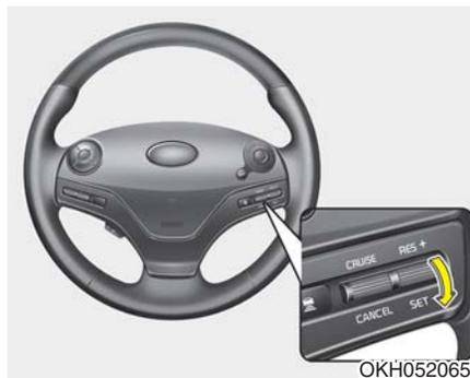
3. 向下移动开关杆(向SET-方向), 并在到达理想速度时释放。LCD显示屏上的、设定速度以及车与车之间距离信息亮。
