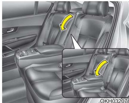
提供额外的货物空间来容纳不能适当安置在关闭的行李箱内的长/窄货物(滑雪橇、杆等)。
