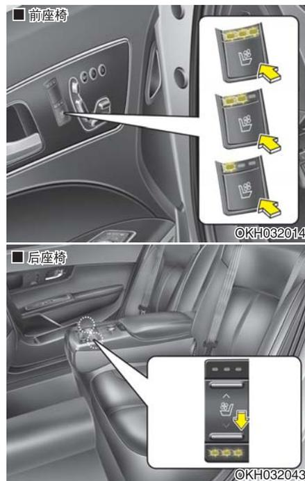
提供了通风座椅，在炎热天气里通过座椅和座椅靠背表面上的小通风口鼓风来冷却座椅。
