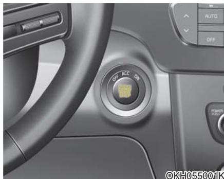
无论何时打开前车门，发动机起动/停止按钮照明灯亮，为您提供方便。关闭车门时，此灯在约30秒后熄灭。防盗警报系统进入警戒状态时，此灯立即熄灭。
