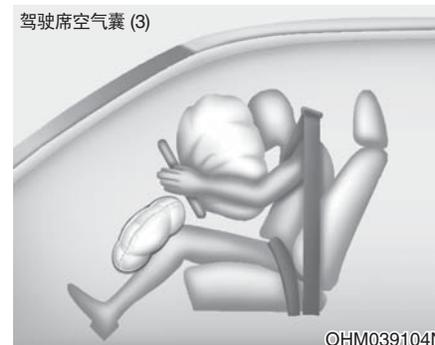
完全展开的空气囊结合安全带的正确保护能减缓驾驶员或乘客的前冲运动，降低头部和颈部受伤的危险。
