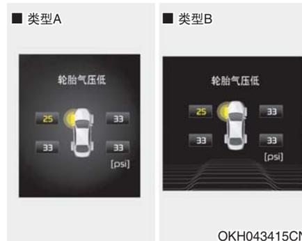
如果轮胎压力监测系统警告灯亮和仪表盘LCD显示器上显示警告信息，说明您车辆的一个或多个轮胎充气压力明显不足。低压轮胎位置警告灯通过点亮对应位置警告灯指示充气压力明显过低的轮胎位置。
