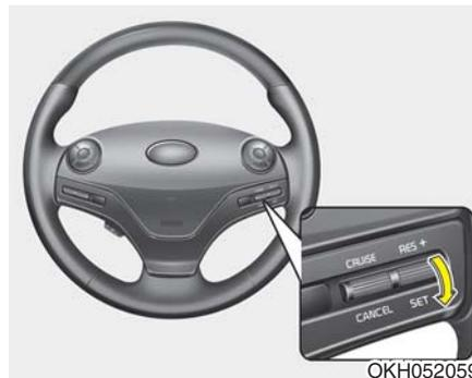
3. 向下压下(到SET-)开关杆, 并在到达理想速度时释放, 设定速度亮。同时释放加速踏板, 车辆会自动保持此理想速度。
