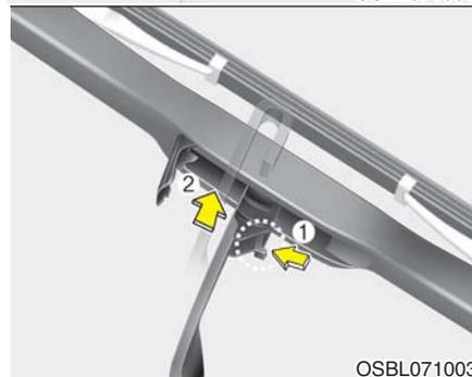
2. 转动雨刮器刮片夹。然后提升雨刮器刮片夹。
