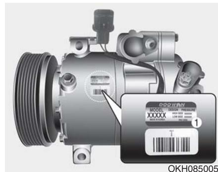
压缩机标签通知您车辆配备的压缩机类型如型号、供应商部件号、生产编号和制冷剂油(1)。
