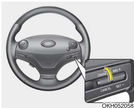
1. 向上移动开关杆(向巡航(CRUISE)方向), 巡航系统ON, 巡航控制(CRUISE)指示灯亮。
