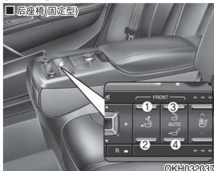
后休闲座椅系统提供乘员舒适性。助手席座椅向前移动并且座椅靠背向前折叠，提供舒适的空间。后右乘员座椅靠背向后倾斜。但如果助手席车门处于打开状态，后休闲座椅系统不工作。
