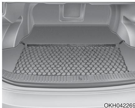
使用载货区中的六个夹具附着行李网,防止物品在载货区内滑动。
