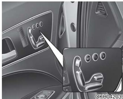
在车辆上提供了驾驶席位置记忆系统，通过简单的按钮操作存储驾驶席座椅位置、室外后视镜位置、HUD\*(平视显示器)位置、仪表盘亮度位置和方向盘位置，以及将它们恢复到所存储位置。根据驾驶员的驾驶习惯，在位置记忆系统中存储不同驾驶员的理想位置，使他们可以便利地恢复到自己所设定的驾驶席座椅位置、室外后视镜位置和方向盘位置。
