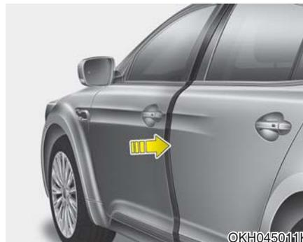
如果车门没有完全关闭但关闭至第一个止动位置, 车门将自动完全关闭。
