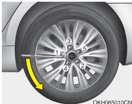
7. 每次向逆时针方向转动每个轮胎螺母一圈来松动轮胎螺母，但在轮胎离地之前不要拧下螺母。
