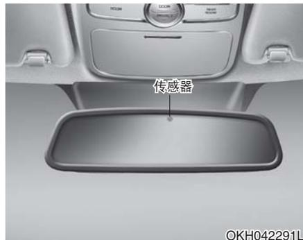
在夜间或低光线驾驶条件下，电控室内后视镜自动控制后方车辆大灯的眩光。装配在室内后视镜内的传感器检测车辆周围的光线强度，自动控制后方车辆大灯的眩光。
