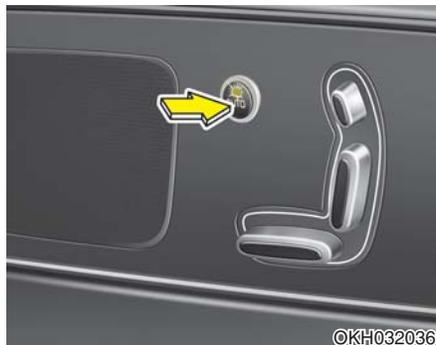
您的车辆配备了便利后座入席的上下车便利系统。打开后车门时，后座椅自动向后移动以便乘员上下车。此上下车便利系统仅在把控制开关置于“ON”位置时工作。
