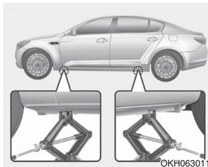
8. 把千斤顶放在最接近被换的轮胎的前顶起部位或后顶起部位，把千斤顶放在车架下的指定位置。顶起部位是焊接到车架上、通过两个凸舌和一个隆起点来指引千斤顶的平板。
