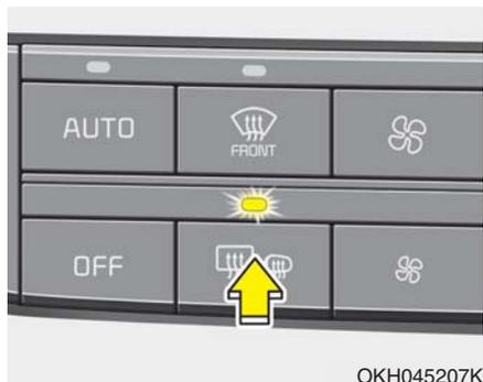
发动机运转期间除霜器加热车窗从而除去后车窗上的霜、雾和薄冰。要启动后车窗除霜器，可以按中央仪表开关板上的后车窗除霜按钮。除霜器ON时后车窗除霜按钮上的指示灯亮。再按一次后窗除霜器按钮也可关闭除霜器。如果后车窗上有厚积雪，则应在操作后除霜器前清除这些积雪。后窗除霜器在20分钟后或者发动机起动/停止按钮OFF时自动关闭，再按一次后窗除霜器按钮也可关闭除霜器。
