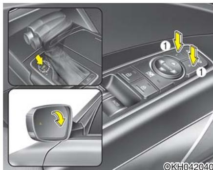
把变速杆挂入“R(倒车)”位置时，室外后视镜向下偏转辅助倒车。根据室外后视镜开关(1)的位置，室外后视镜如下工作：
