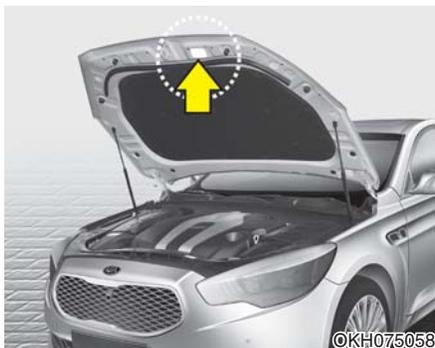
制冷剂标签位于发动机罩底部。
