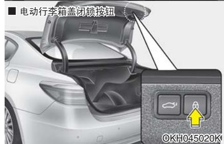
可使用智能钥匙、电动行李箱盖主开关、行李箱盖手柄开关或行李箱盖上的关闭按钮自动打开和关闭电动行李箱盖。
