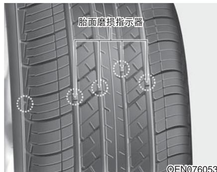
如果轮胎磨损均匀，胎面磨损指示器将出现横过胎面的硬带，这表示胎面剩余厚度小于1.6mm，此时应更换轮胎。
