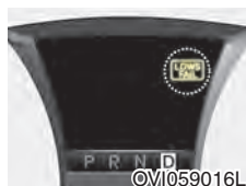
车道偏离警告系统 故障警告灯 (如有配备)
