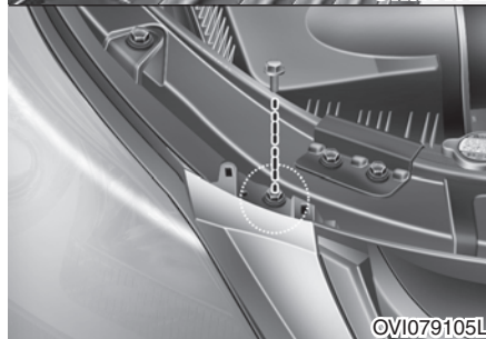
9. 拆卸格栅上的4个紧固件并拧下螺栓。
