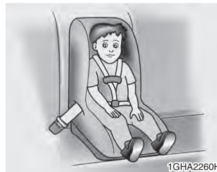
通过腹部安全带安装儿童保护系统(在中央后座椅上)(如有配备)
