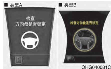
如果将发动机启动/停止按钮转到“OFF”位置时方向盘不正常闭锁，LCD显示器上的警告显示10秒钟。警告蜂鸣音响3秒钟，发动机启动/停止按钮指示灯闪烁10秒钟。
