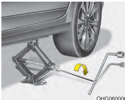
8. 把千斤顶手柄插入千斤顶并顺时针旋转。举升车辆直到轮胎离地，离地间隙约30mm(1.2in)。拆卸车轮螺母前，确认车辆平稳，并且没有滑动或移动的危险。
