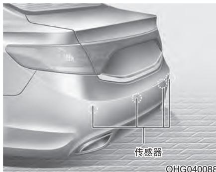
在倒车过程中，后驻车辅助系统向驾驶员提供帮助。如果检测到在车辆后方120cm (47in.)的距离内有物体存在，该系统会发出警告音。该系统是一个辅助系统而且既不能预测也不能因为配备了该系统而放松警惕，检测范围和可检测的物体受后部传感器的限制。无论何时进行倒车操作，都应像没有配备后驻车辅助系统一样多加注意车后的物体。
