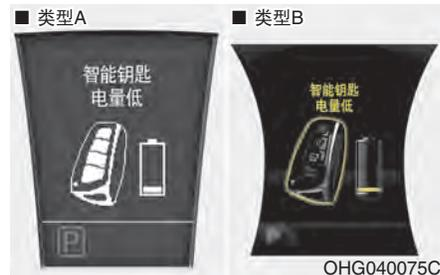
如果车辆内智能钥匙电池亏电时将发动机启动/停止按钮转到“OFF”位置，LCD显示器上的警告显示约10秒钟，警告蜂鸣器响一次。要更换新电池。
