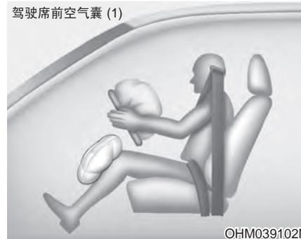
前安全气囊位于方向盘中央、手套箱上的助手席前仪表板内和/或驾驶员侧膝垫内。SRSCM检测到足够严重的正面碰撞时，自动展开前安全气囊。
