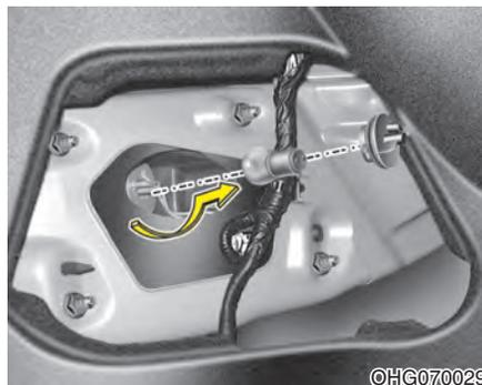
4. 逆时针转动灯座，对正灯座舌片与总成导槽，从总成上拆卸灯座。
