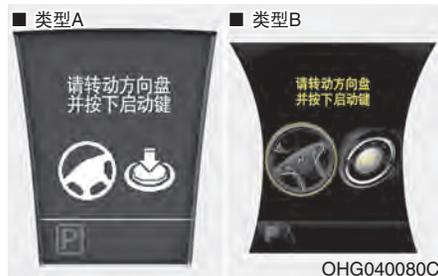
如果按下发动机启动/停止按钮时方向盘不正常开锁，LCD显示器上的警告显示10秒钟。警告蜂鸣音响一次，发动机启动/停止按钮指示灯闪烁10秒钟。您接收到提醒信息时，在左右转动方向盘的过程中按下发动机启动/停止按钮。
