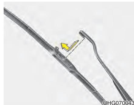
3. 按拆卸的反顺序安装新雨刮器刮片总成。
