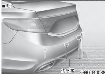
车辆移动中如果检测到车前60cm(24in.)范围内和车后100cm(39in.)范围内有物体，驻车辅助系统通过发出警告蜂鸣音协助驾驶员。该系统是辅助系统，既不能预测也不能因为配备了该系统而放松警惕。
