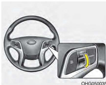
3. 按下SET-开关并在达到需要的速度时释放，仪表盘中的SET指示灯亮起，同时释放加速踏板，则车辆会自动保持该设定的速度。
