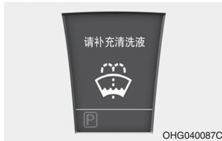
喷水器液储液箱接近空时这个警告灯亮约12秒钟。要使这个警告灯立即熄灭，请按下RESET按钮1秒以上时间。尽快再补充喷水器液。
