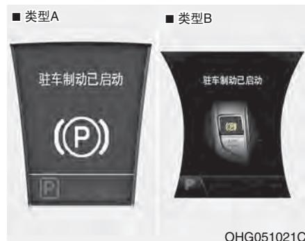
在自动固定功能工作期间，如果因ESP(电子稳定程序)信号使EPB应用，警告音响并显示警告信
