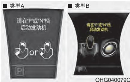
如果在变速杆没有挂入“P(驻车)”位置或“N(空档)”位置的状态下启动发动机，LCD显示器上的警告显示约10秒钟。您也可以将变速杆挂入“N(空档)”位置的状态下启动发动机，但为了您的安全，请在变速杆挂入“P(驻车)”位置的状态下启动发动机。
