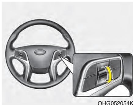
3. 推SET-开关并在到达理想速度时释放。LCD显示屏上显示SET指示灯、设定速度和与前车之间的距离。
