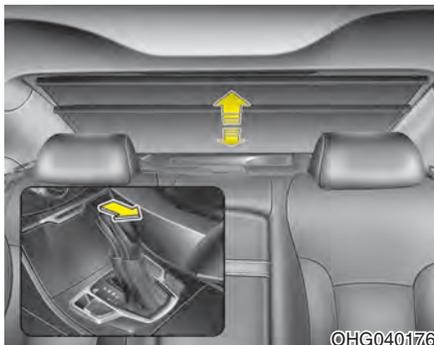
将变速杆置于“R(倒档)”位置时自动折叠后窗帘，将变速杆从“R(倒档)”移动到“P(驻车)”位置时自动展开后窗帘。
