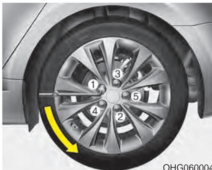
6. 每次向逆时针方向转动每个轮胎螺母一圈来松动轮胎螺母，但在轮胎离地之前不要拧下螺母。
