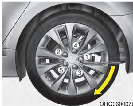
然后按图示放置扳手并拧紧车轮螺母。要确保套筒完全套在螺母上。禁止站在扳手手柄上或在扳手手柄上使用延长管。
