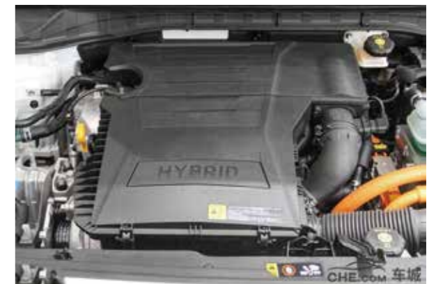
起亚 NIRO “Kappa” 阿特金森循环自然吸气发动机
