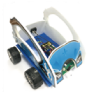
通过车头前部特定的传感器设置，模型车遇到障碍物时自动停车。
