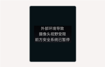
前视摄像头遮挡警告示例
