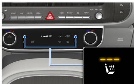
1. 发动机运转期间，请按下前排暖风 & 空调控制系统上的**后 (Rear)** 图标键。
