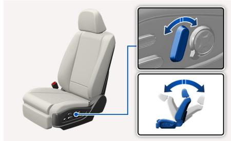
向前/向后拨动控制开关，调整座椅靠背角度。
