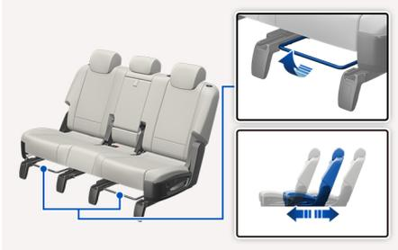
向上拉起并持续按住座椅滑动调整杆，同时滑动座椅。在滑动座椅至理想位置时释放调整杆。
