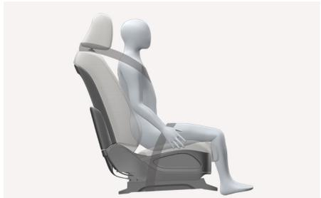
如果在副驾驶座椅上坐有成年人时**副驾驶气囊停用(PASSENGER AIR BAG OFF)**警告灯亮，将发动机启动/停止按钮转至OFF位置，并告知副驾驶乘员正确就坐。重新启动发动机，并告知副驾驶乘员保持其正确坐姿。这将使乘员分类系统(OCS)检测到成年乘员，并启用副驾驶气囊。
