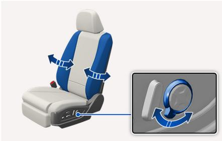
顺时针转动调整旋钮，座椅靠背撑垫向内侧合拢。逆时针转动调整旋钮，座椅靠背撑垫向外侧合拢。
