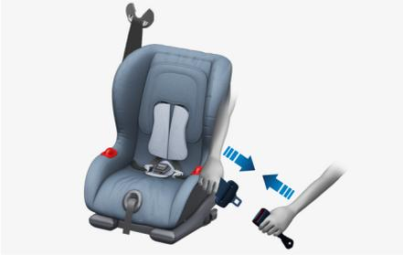
3. 向下按压儿童保护座椅 (CRS)，并拉紧肩部 / 胯部安全带束带，将安全带束带的松弛部分尽可能收回至卷带器内，以此完全消除松弛部分。
