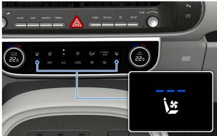
在发动机运转状态下，操作驾驶位座椅或副驾驶座椅的冷却图标键，可以冷却驾驶位座椅或副驾驶座椅。
