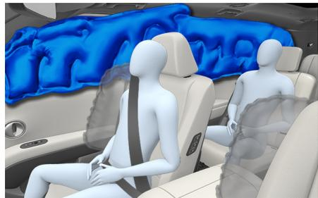
侧气帘位于两侧的前/后车门上方车顶纵梁上。
