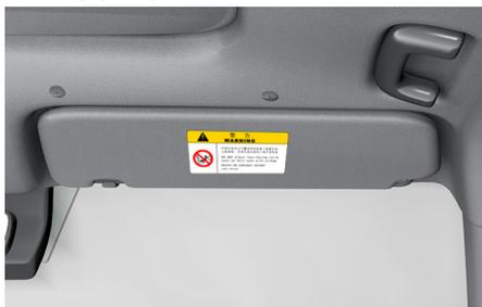
为了警告驾驶员和乘员气囊系统的潜在危险性，在车辆上粘贴有气囊警告标签。一定要仔细阅读并熟悉在《车主手册(使用说明书)》内描述的车辆配备气囊系统有关的所有信息。
