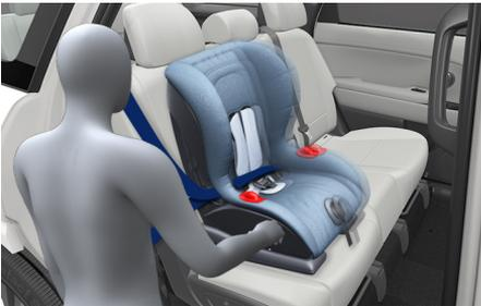
如果儿童保护座椅制造商指导或建议顶部拴带和肩部/胯部安全带配合使用，详细信息请参考“使用“顶部拴带固定锚”系统紧固儿童保护座椅(CRS)”部分。
