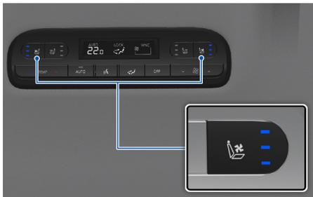
发动机运转期间，操作座椅冷却按钮，可以启动通风座椅功能冷却座椅。
