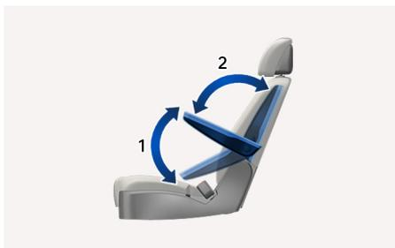
将扶手向前拉至最低位置后, 再向上抬起并固定至舒适角度。
