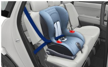
2. 将肩部 / 胯部安全带卡扣扣入至正确的扣环内。直至听到明显的“咔嗒”声。
