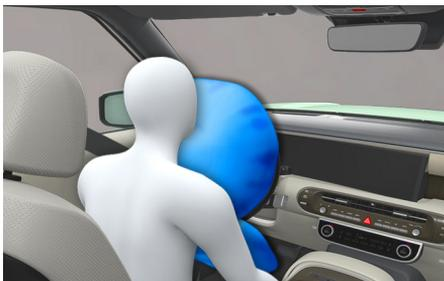
2. 气囊展开时，装饰盖内侧模压裂缝会在气囊膨胀压力作用下被撕开。
