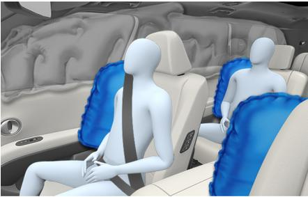
在每个前座椅上均配备了侧气囊和侧气帘。此外，在驾驶位座椅靠背的内侧位置配备了前中央侧气囊。
