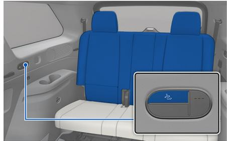
1. 按下 3 排左侧 / 右侧装饰板上的 3 排座椅靠背角度调整开关。
