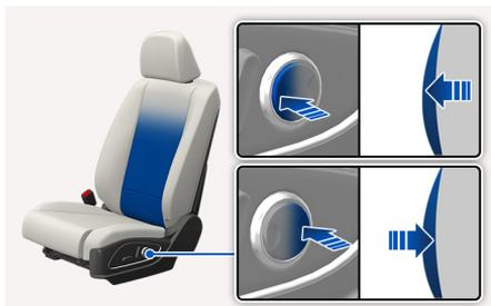
按下调整开关的前部，座椅腰垫突出；按下调整开关的后部，座椅腰垫缩进。
