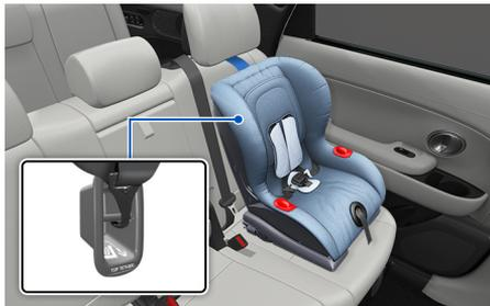
3. 试着向前 / 向后 / 向左 / 向右推拉儿童保护座椅 (CRS)，检查儿童保护座椅 (CRS) 是否牢固固定。
