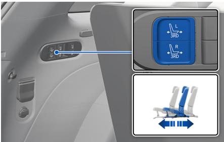
1. 按下 3 排左侧 / 右侧装饰板和行李箱侧面装饰板上的 3 排座椅向前 / 向后调整开关。
