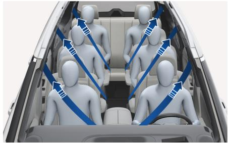
您的车辆在驾驶位侧、副驾驶位侧和后乘员座椅(如有配备)上均配备了安全带拉紧器(卷带拉紧器)。配备安全带拉紧器的目的是，为了在发生一定程度的正面或侧面碰撞事故时，确保安全带紧固乘员的身体。发生正面或侧面碰撞事故，其严重性达到一定程度时，安全带拉紧器会与气囊一起启动工作。
