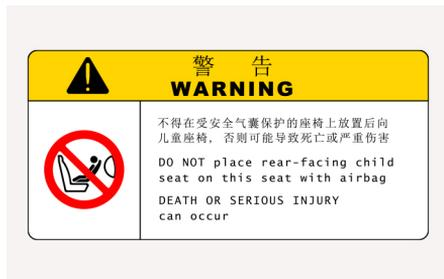
除非禁用副驾驶正面气囊，否则禁止在副驾驶座椅上安装儿童保护座椅(CRS)。
