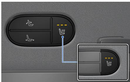
发动机运转期间，操作座椅加热按钮，可以启动座椅加热器加热后座椅。
