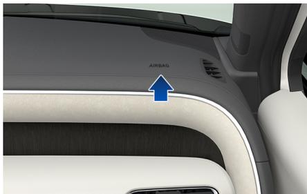
辅助保护系统(SRS)包括安装在方向盘中央的驾驶位正面气囊、安装在副驾驶前手套箱上方仪表板内侧的副驾驶正面气囊。
