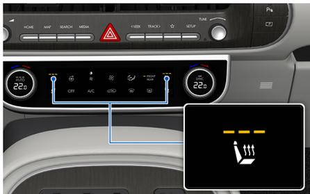
在发动机运转状态下，操作驾驶位座椅或副驾驶座椅的加热按钮，可以加热驾驶位座椅或副驾驶座椅。
