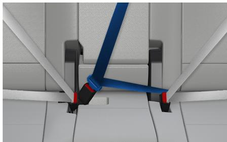
将金属卡扣插入至扣环中，直至听到“咔嗒”声，表示卡扣正确锁入在扣环内。拉动安全带束带的肩带部分，使安全带束带舒适绕过您的胯部，并消除松弛部分。确认安全带束带没有扭结。
