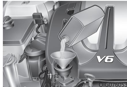
仅能使用规定规格发动机机油。
