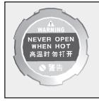
**禁止在发动机和散热器热态时拆卸散热器盖或排放螺塞。滚烫冷却水和蒸气会在压力作用下喷出，导致严重伤害。**
