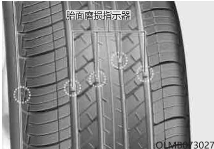
如果轮胎磨损严重而且均匀，会露出横过胎面的实心带式磨损指示器。这表示胎面剩余厚度不足1.6mm。此时应更换轮胎。
