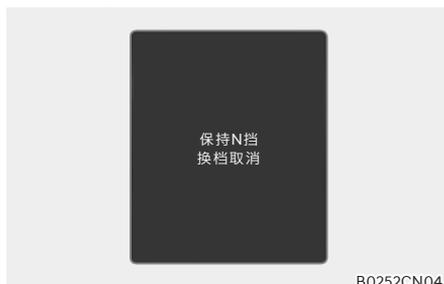
在仪表盘LCD显示屏上显示“保持N挡模式，请长按方向盘OK键”的提示信息时，按下方向盘上的[OK]按钮，就会显示此警告信息。此时，发动机关闭后，档位保持在“N(空挡)”档。
