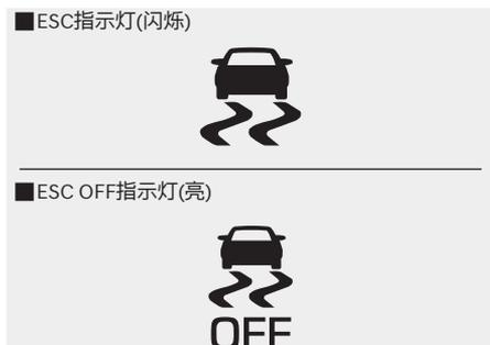
将发动机起动/停止按钮转至[ON]位置时，[ESC]指示灯亮，然后在电子稳定控制(ESC)系统正常工作时熄灭。
