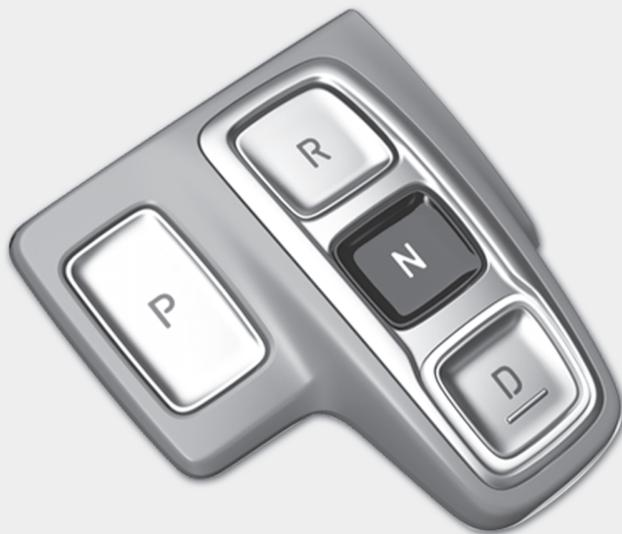
踩下制动踏板，然后按下换挡按钮进行换挡或挂入“P(驻车)”档。
