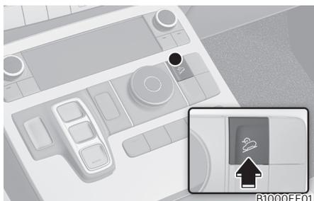
下坡辅助制动控制(DBC)功能在驾驶员不操作制动踏板的状态，辅助驾驶员驾车驶下陡坡。
