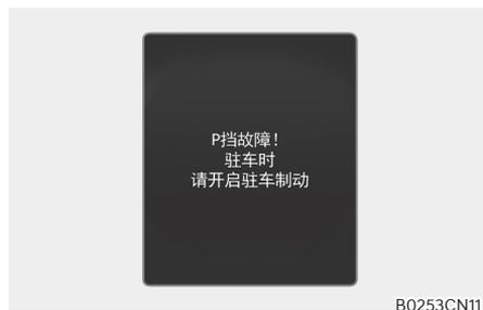
如果驻车制动器存在故障，就会显示此警告信息。在此状态下，我们建议您将此系统有关的所有检查、维修和更换工作交由现代汽车授权经销商进行。
