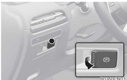
要应用电控驻车制动器(EPB)，执行下列操作：
