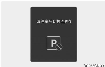
如果试图在车辆移动时将档位挂入“P(驻车)”档，就会显示此警告信息。
