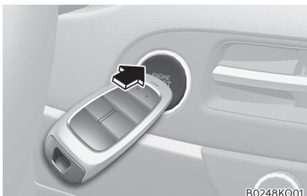
如果智能钥匙电池电量不足或智能钥匙不能正常工作，如图所示，直接用智能钥匙按下发动机起动/停止按钮起动发动机。
