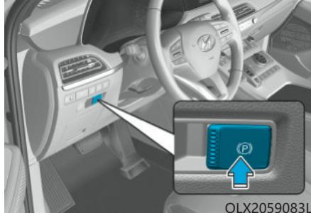
要释放电控驻车制动器(EPB)，在下列条件下，按下EPB开关：
