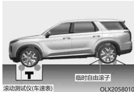
**不要用2WD测功器测试全时4WD车辆。如果必须用2WD测功器，请遵循下列程序：**
