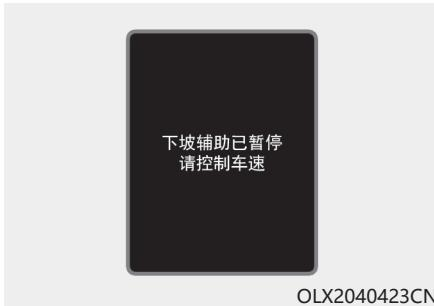
**下坡制动控制禁用。控制车速**
