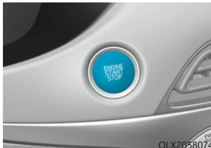
无论何时打开前车门，发动机起动/停止按钮照明灯亮，车门关闭30秒钟之后照明灯OFF。
