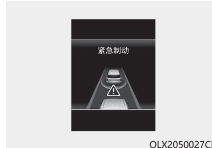
在LCD显示器上显示此警告信息，并发出警报声。
