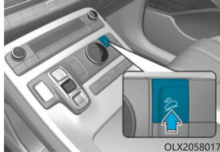
下坡制动控制(DBC)在驾驶员没有踩下制动踏板的状态帮助驾驶员驾车驶下陡坡。
