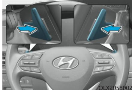
档位在“D(前进)”档时，可以用拨片换挡开关进行换挡。
