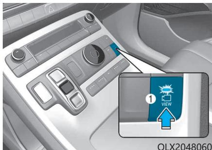
全景影像系统能辅助驾驶员在驻车操作时观察车辆周围环境状态。按下按钮(1, 指示灯ON)时启动系统。重新按下按钮时解除系统(1, 指示灯OFF)。
