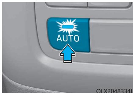
按照设定的目标温度自动控制后排空调控制系统。
