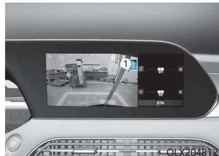
当您触摸图标(1)时，在显示屏上会显示顶部视图，并显示本车辆后部目标车辆的距离。再次触摸图标(1)时，转换到之前的显示屏。
