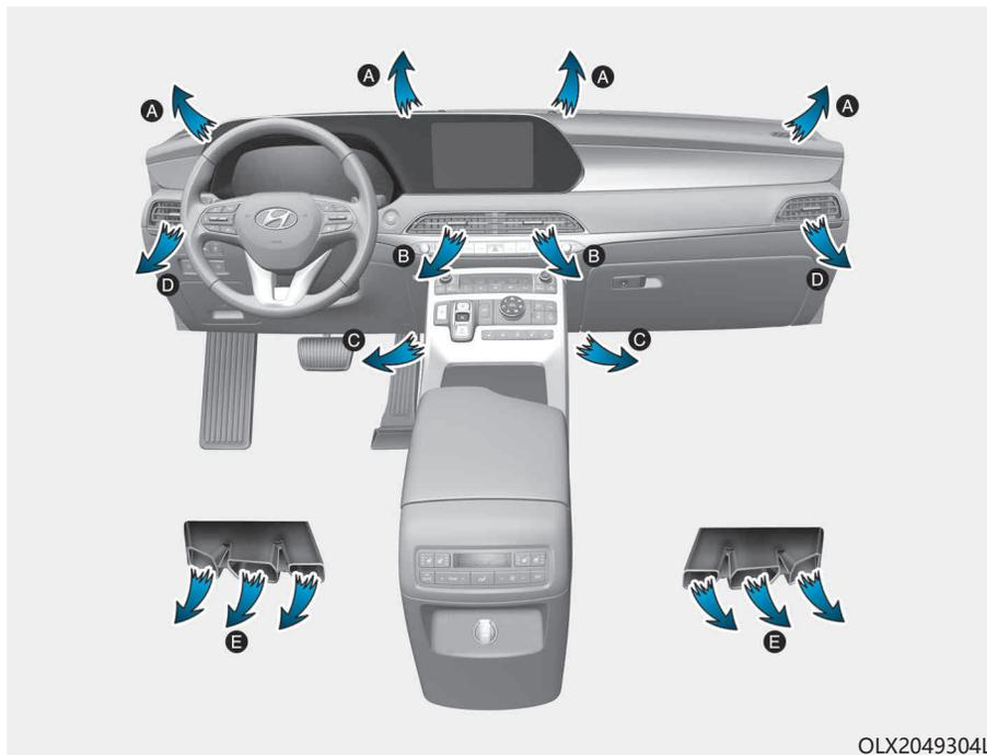
通风模式选择按钮控制从通风系统流出的气流方向。
