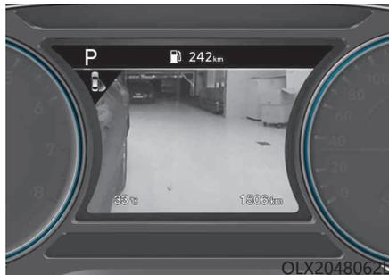
后侧方盲区图像显示(BVM)系统启动时，在仪表盘LCD显示器上会显示后左侧方/后右侧方区域图像。
