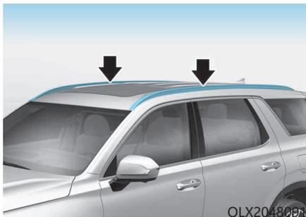
如果本车辆有车顶行李架，您可以在车顶上装载货物。
