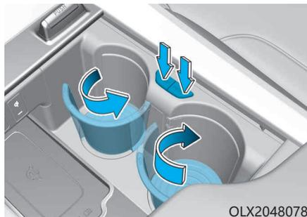
按下按钮可打开盖。按下按钮，杯架从前控制台伸出。使用后将杯架安全按回。
