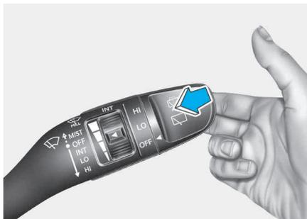
在OFF位置，朝您的方向轻拉雨刮器控制杆，向挡风玻璃喷射清洗液并运转雨刮器1-3周期。
