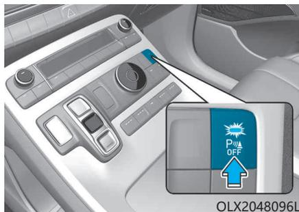
按下按钮时，关闭驻车距离警告系统。按钮上的指示灯亮。
