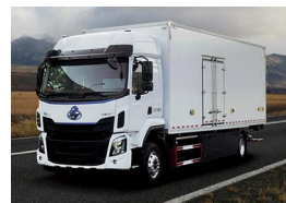
18 吨燃料电池翼开启 厢式车
