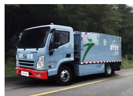
4.5 吨燃料电池密闭式 桶装垃圾车
