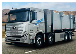
32 吨燃料电池厢式垃圾车
